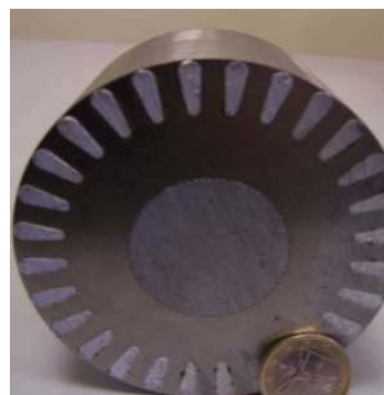
Coupe de face d'un rotor complet
