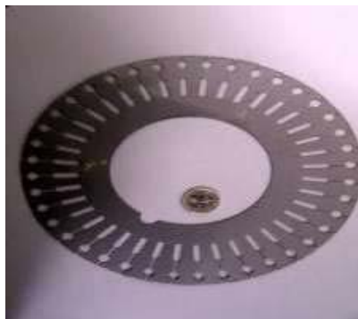
Tôle magnétique (ici double encoche)
