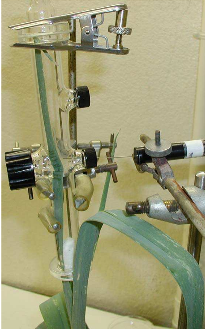
Fig. 34: Dispositif expérimental utilisé pour le piégeage des odeurs en SPME. (cliché D. Pierre).
