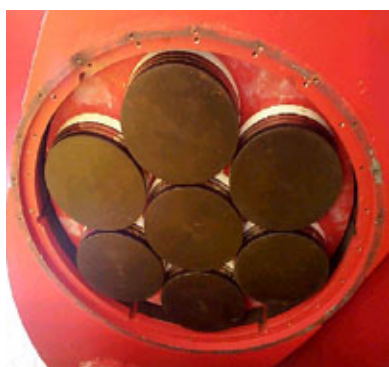
Figure 2.16 Antenne du sondeur de sédiments, constituée des 7 transducteurs Tonpiz élémentaires, montée sous la coque du N/O Le Suroît
