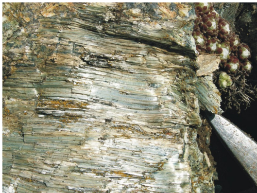
Fig. 3.2 – Vena di antigorite fibrosa: le fibre hanno lunghezza centimetrica. Fibrous antigorite veins: the fibers have a centimetric length.
