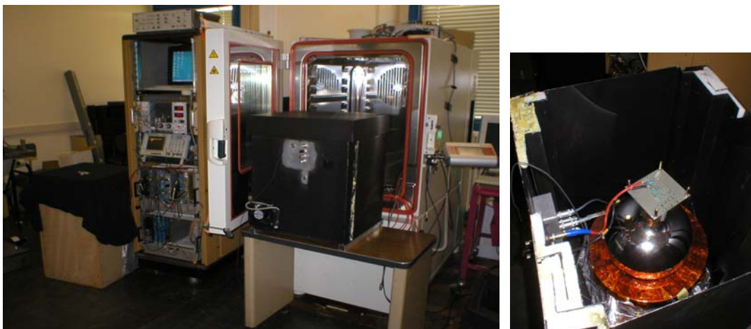
Figure A-9 : Photographie du banc de test dédié aux mesures de bruit de fond et de post impulsions. La photographie de droite montre une vue intérieure de la boîte noire.
