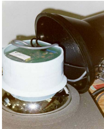
Figure B-13 : Protection du photomultiplicateur.
