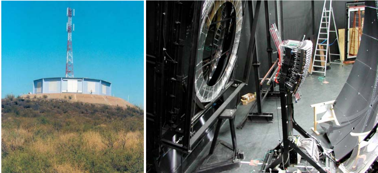
Figure B-10 : Photographies du détecteur de fluorescence Los Leones et d'un de ces télescopes.
