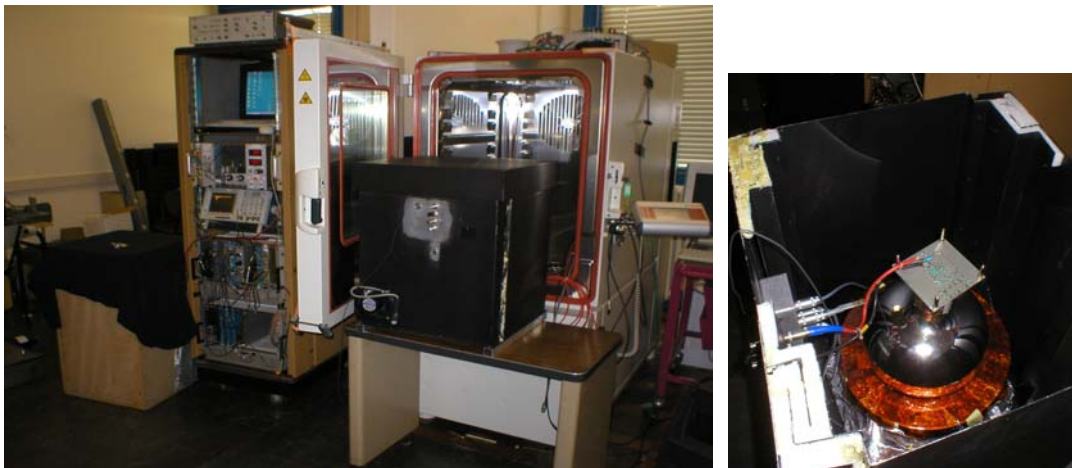
Figure A-9 : Photographie du banc de test dédié aux mesures de bruit de fond et de post impulsions. La photographie de droite montre une vue intérieure de la boîte noire.
