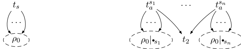
Figure 6.14 — À gauche, le graphe de la relation de priorités de \pi_s(P) ; la transition t_s est celle de P_s . À droite le graphe de la relation de \pi_a(P) . La notation \rho_0|_{\bullet s_i} représente la relation \rho_0 restreinte aux transitions de \bullet s_i ; les t_a^{s_i} sont les transitions résultant de la synchronisation sur clear . Les graphes des \rho_0|_{\bullet s_i} ne sont pas nécessairement disjoints.
