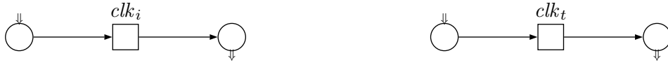
Figure 1.9 — À gauche, le M-net N_i permettant d’initialiser l’horloge ; à droite, le M-net N_t permettant de la terminer.
