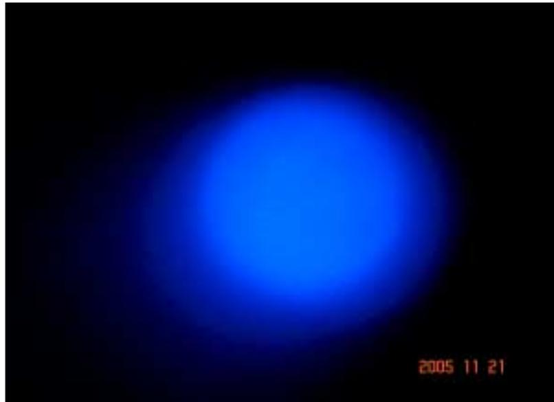
**Figure 5.18** – *Lumière émise par une DEL avec cinq puits quantiques et un courant continu de 100mA.*
