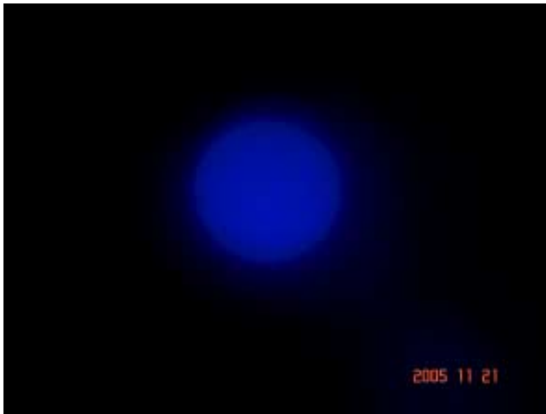
Figure 5.15 – Lumière émise par une homojonction p/n lors de l'application d'un courant direct continu de 100mA.
