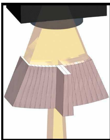
Figure II.11 : Schéma d'un collimateur multi-lames binaire avec une géométrie « en tranche » [Dyk2001].
