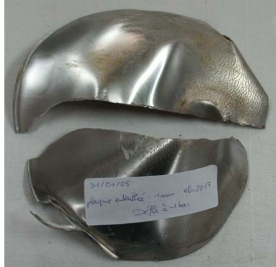
Figure 4.28 : Al2017 d'épaisseur 1 mm – déflagration avec P_i = 1 \text{ bar} .
