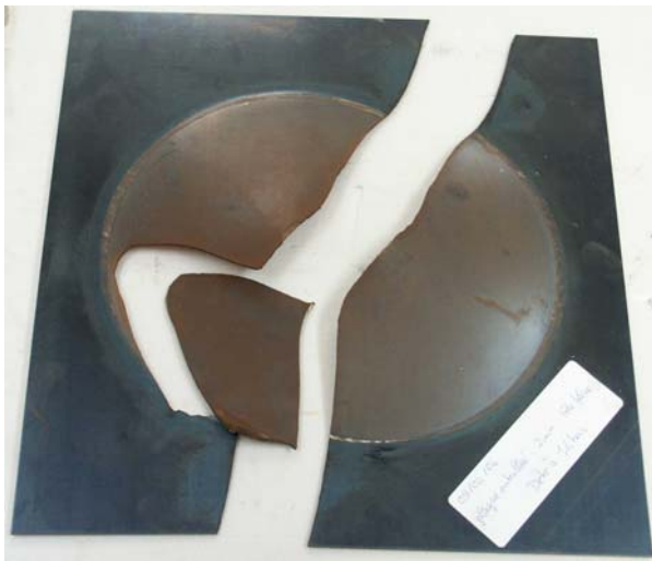
Figure 4.21 : Acier XC65-90 d'épaisseur 2 mm – détonation avec P_i = 1,4 bars.
