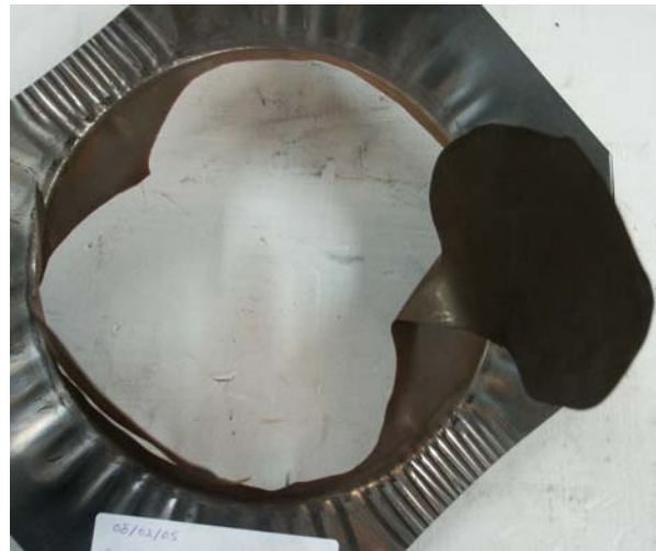
Figure 4.31 : Acier XC65-90 entaillé d'épaisseur 0,5 mm (déflagration avec P_i = 1 bar).
