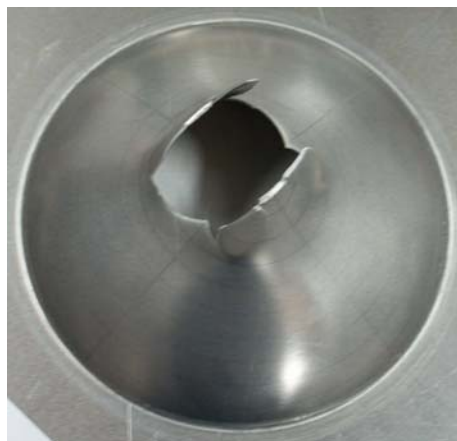
Figure 4.14 : Al5754 d'épaisseur 2 mm en détonation ( P_i = 1,6 \text{ bars} ).
