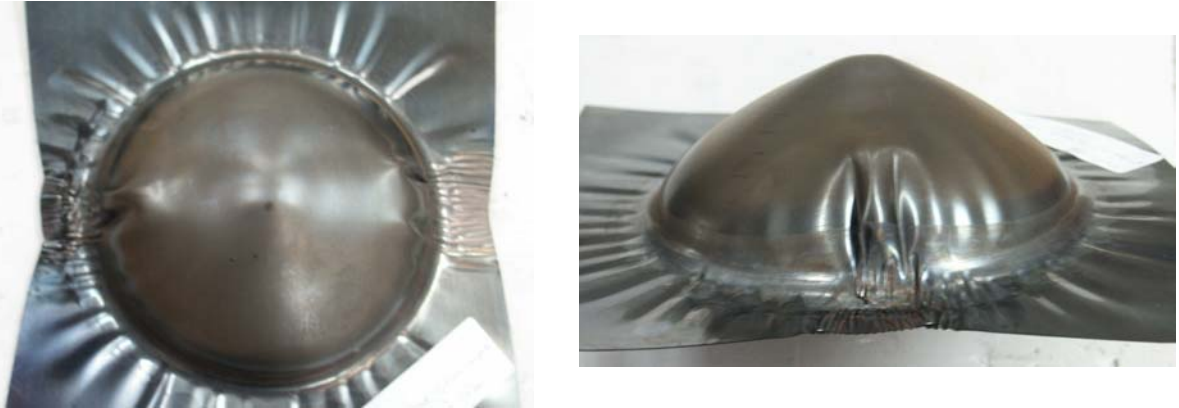
Figure 5.5 : Plaque d'acier XC65-90 d'épaisseur 0,5 mm – déflagration avec P_i = 1,6 bars.
