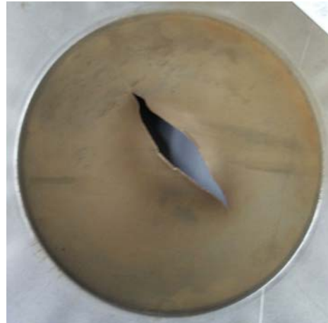
Figure 4.9 : Acier DC01 entaillé d'épaisseur 0,8 mm (déflagration à 1,6 bars).
