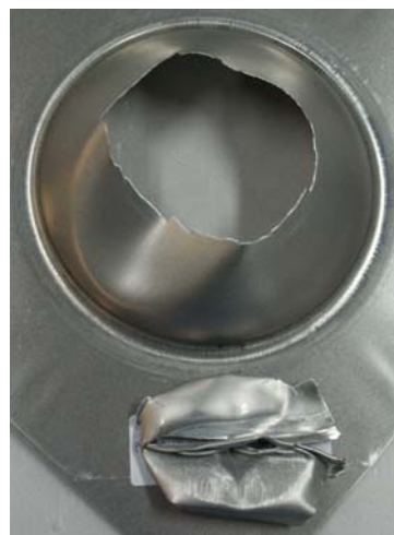
Figure 5.12 : Calotte formée (Al 5754) pour une détonation ( P_i = 1,3 bars) : 2 nd essai.
