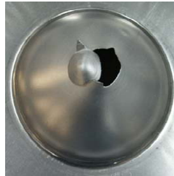
Figure 5.10 : Calotte formée (Al 5754) pour une détonation ( P_i = 1,2 bars) : 2 nd essai.
