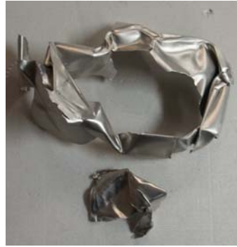
Figure 5.21 : Fragments éjectés (Al 5754) (0,5 mm) pour une détonation ( P_i = 0,8 bar).
