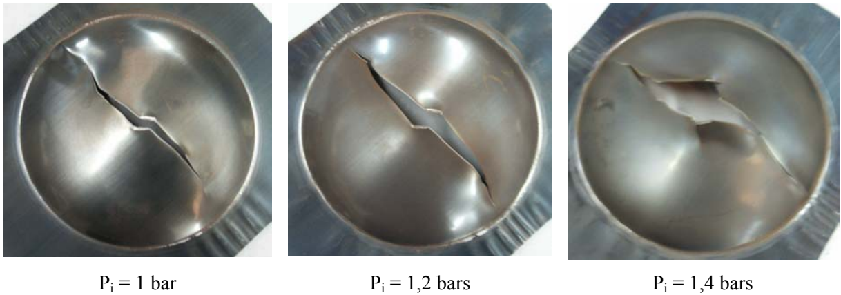
Figure 4.34 : Acier XC65-90 d'épaisseur 1 mm en déflagration.
