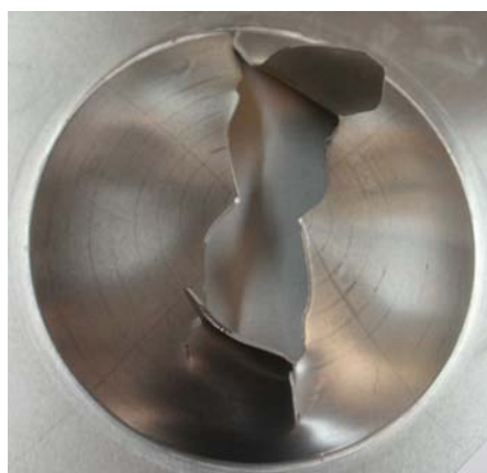
Figure 4.25 : Al2017 d'épaisseur 2 mm – détonation avec P_i = 1,6 bars.
