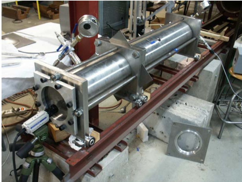
Figure 4.2 : Photo du dispositif de visualisation par caméra rapide.
