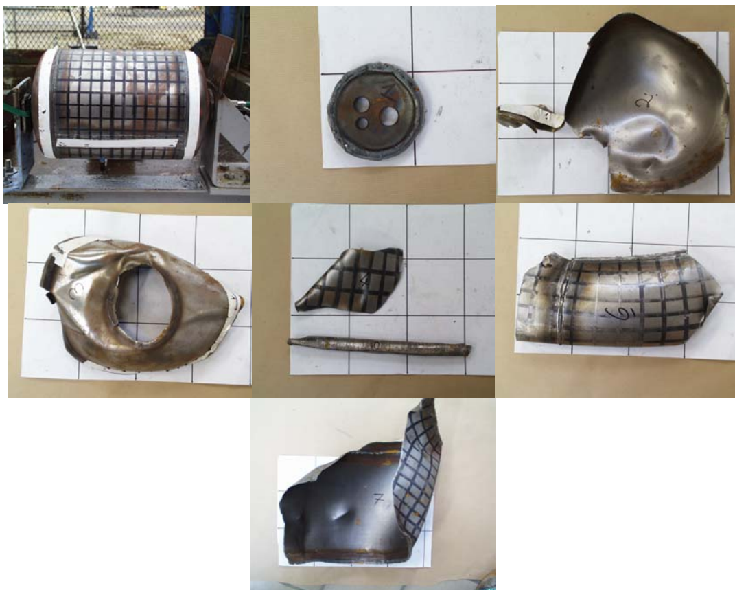
Figure 3.2 : Photographies du réservoir (essai n°5 sur acier DC01) avant et après l'essai.
