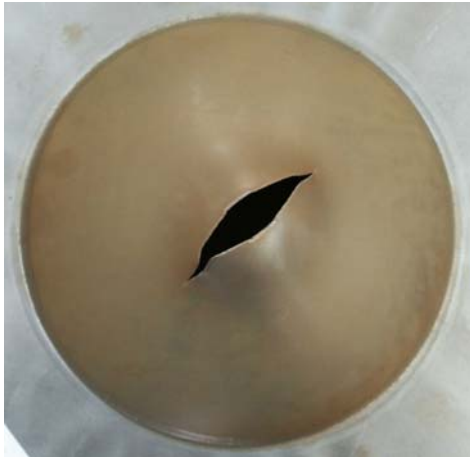
Figure 4.8 : Acier DC01 entaillé d'épaisseur 0,8 mm (détonation à 1,6 bars).
