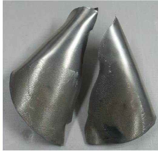
Figure 4.17 : Al5754 entaillé d'épaisseur 1 mm (détonation avec P_i = 0,8 bar).
