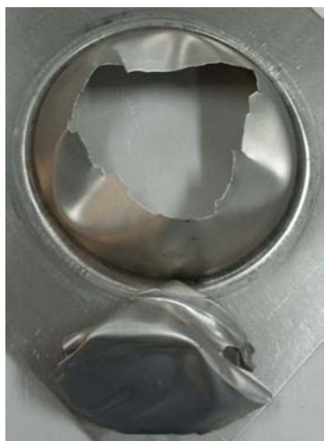
Figure 5.11 : Calotte formée (Al 5754) pour une détonation ( P_i = 1,3 bars) : 1 er essai.
