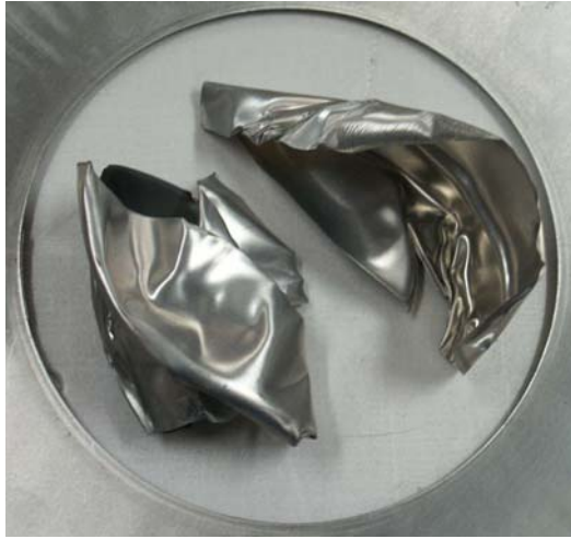
Figure 4.16 : Al5754 entaillé d'épaisseur 0,5 mm (détonation avec P_i = 0,6 bar).
