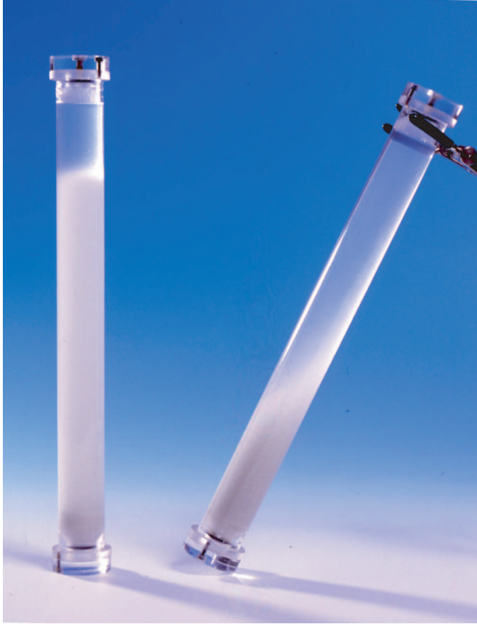
FIGURE 1.19: Effet Boycott lors de la sédimentation d'une suspension de particules dans un tube incliné. A gauche le tube est vertical, à droite il est incliné à 30^\circ par rapport à la verticale. Les photos ont été prises après le même laps de temps suivant la fin de l'agitation homogénéisant la suspension (photos extraites de la référence [31]).
