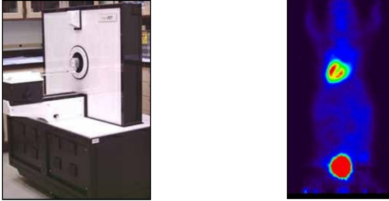
Figure I.4 : Gauche : image d'un microTEP – Droite : acquisition microTEP de 10 min (854 \mu\text{Ci} ^{18}\text{F} -FDG) [Stout D, Crump Institute for Molecular Imaging, LA]. On distingue la vessie et le cœur (myocarde).
