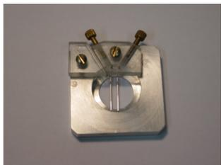
**Figure II-3.** Image d'une chambre d'électroformation. On distingue les deux électrodes de platine sur lesquelles est déposée la solution lipidique.
