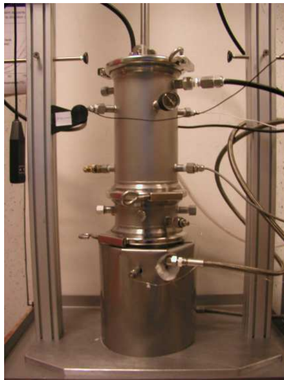
Figure V- 4 : Photos du dispositif expérimental. a- Enceinte climatique ouverte, le support d'échantillon est accessible. b- Dispositif en fonctionnement, enceinte climatique fermée, échantillon immergé dans l'eau à l'intérieur de l'enceinte
