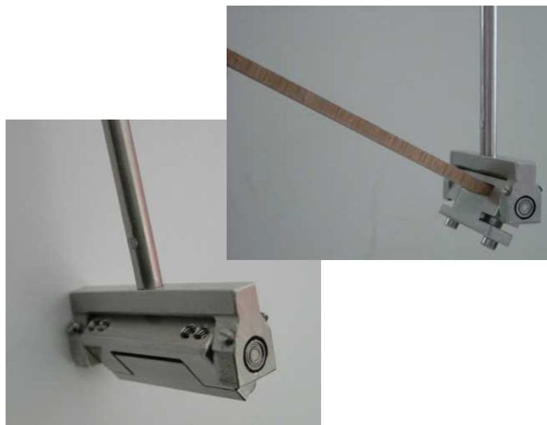
Figure V- 7 : Photo des mors de sollicitation
