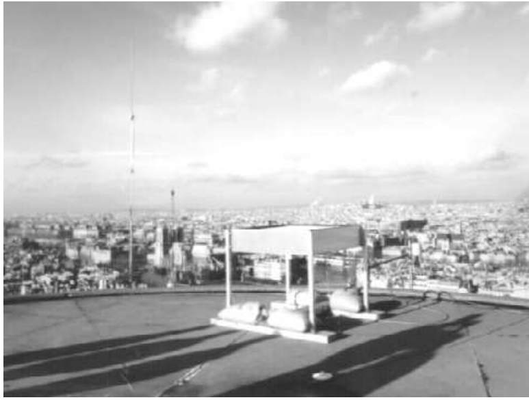
FIG. B.4 – Implantation du sodar sur le toit de la Tour Centrale de l'Université P.M Curie
