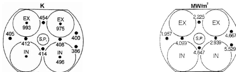
Fig. 1.26 : Température et flux maximal sur la culasse – 3000tr/min [Choi et al., 1997]
