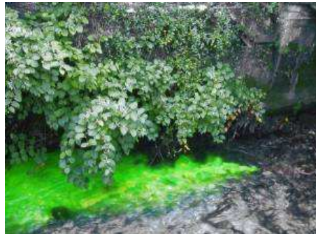
FIG. 1.1: Jaugeage par dilution. Un traceur coloré (ici de la fluorescéine verte) est injecté dans l'écoulement de la rivière. Photo : P. Bois, LTHE.
