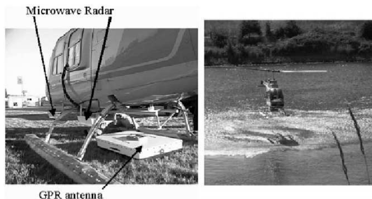
FIG. 3.2: L'hélicoptère et son équipement (antennes Radar et GPR) utilisé par Melcher et al. (2002) (photos : USGS).
