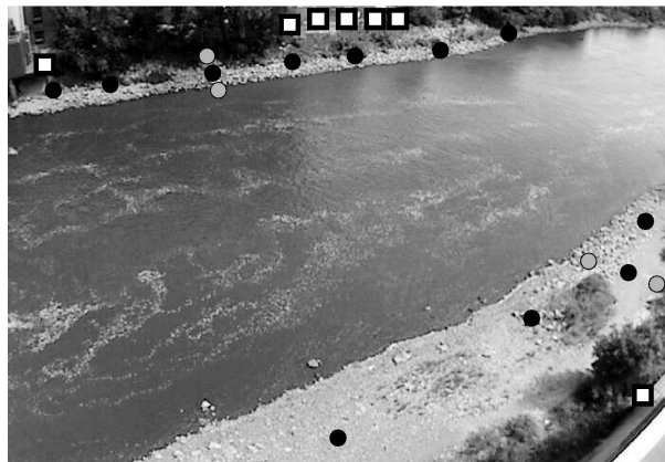
FIG. 5.4: Localisation des points de référence relevés par théodolite sur le terrain.
