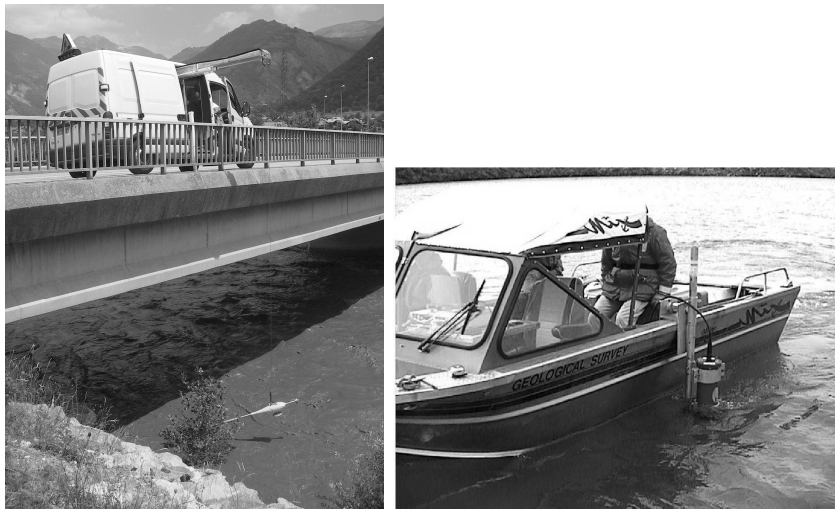
FIG. 2.6: Jaugeage du Rhône au moulinet (photo : P. Belleudy) et mesure à l'ADCP depuis un bateau (photo : USGS). L'équipement nécessaire (potence et pont pour le moulinet et bateau pour l'ADCP) est important.
