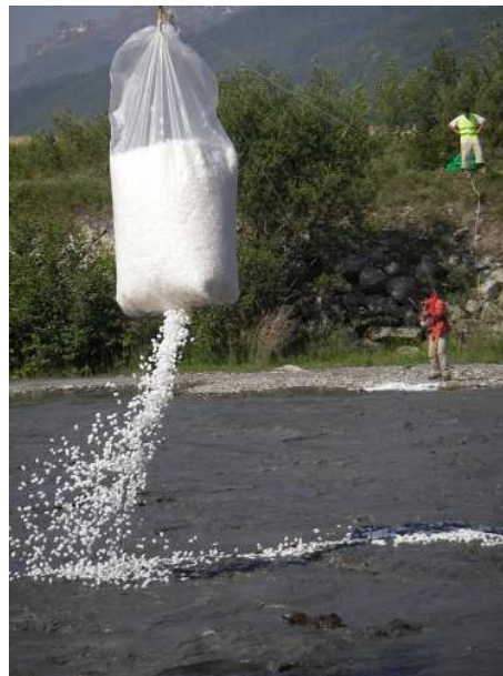
FIG. 10.1: Système de tyrolienne pour déposer des traceurs artificiels (chips de maïs) sur toute la surface de la rivière. Photo : P. Belleudy.
