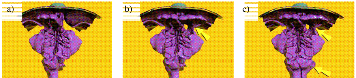
Figure 2-12 : Représentation de l'effet du seuil de segmentation sur la reconstruction 3D d'une géométrie de VAS d'un patient vue du dessus des cavités nasales : a) le seuil 469 jugé « insuffisant », élimine le sinus frontal droit, b) le seuil 569, « correct », inclus le sinus frontal droit, c) le seuil 669 induit un artefact en incluant un sinus non connecté via l'ostium. Les flèches jaunes indiquent les différences observées sur les deux dernières reconstructions (b et c) par rapport à la première (a).
