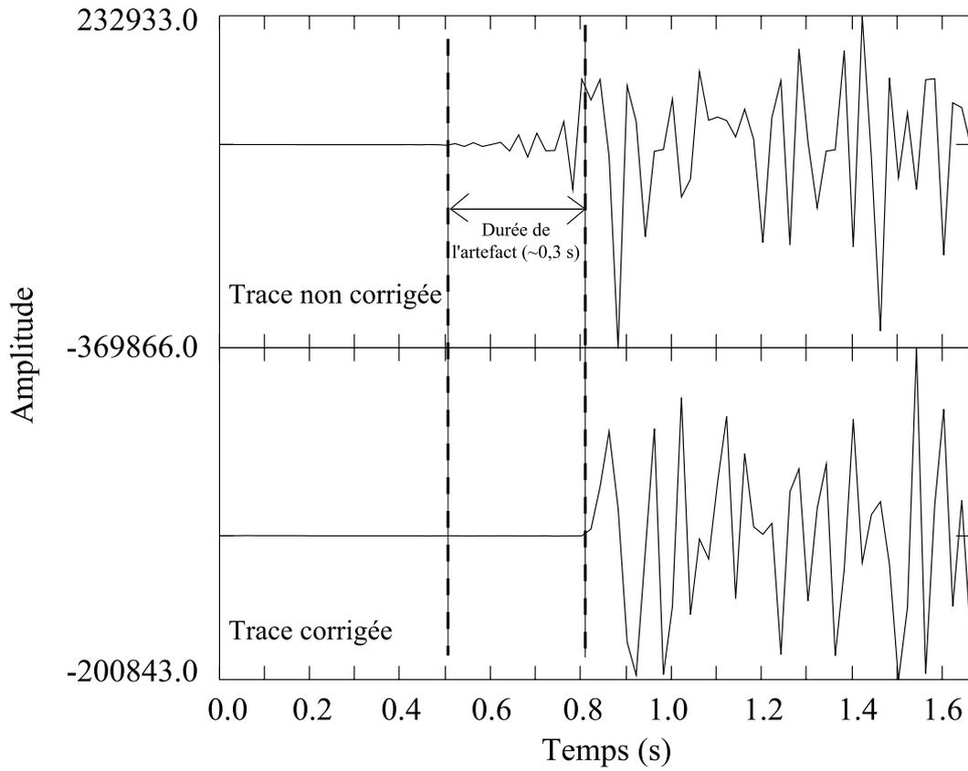
FIG. 2.7 – Exemple de correction de l'effet FIR à la station QUIF du LDG, sur un signal enregistré pour la réplique principale (10h06 T.U.) du séisme de Lorient du 30 septembre 2002. L'artefact mis en évidence a ici une durée d'environ 0,3 s.
