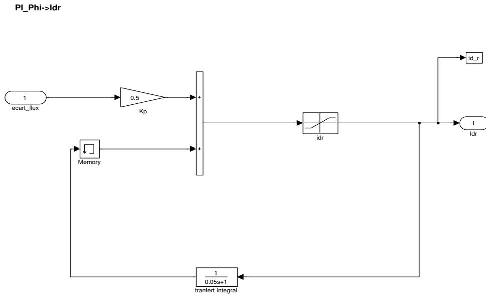
FIG. C.14: Noyau du contrôleur à structure PI.
