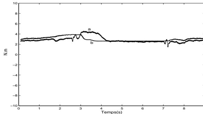
FIG. 4.8: +50% sur  $R_r$ . a) Couple de charge mesuré, b) Couple de charge estimé (N.m) en fonction du temps (s).
