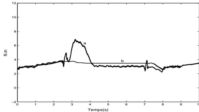
FIG. 4.38: a) Couple de charge mesuré, b) Couple de charge estimé (N.m) en fonction du temps (s). Commutation Observateur/Estimateur.
