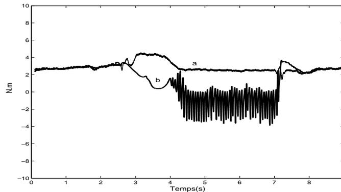
FIG. 4.36: a) Couple de charge mesuré, b) Couple de charge estimé (N.m) en fonction du temps (s).
