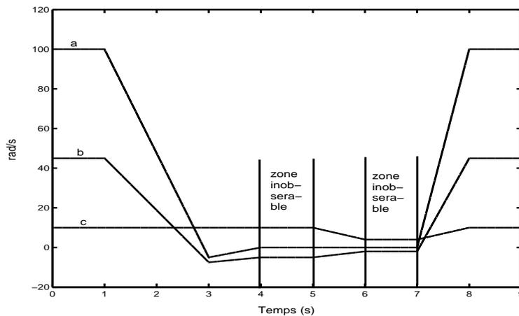
FIG. 3.3: Trajectoires du Benchmark Observateur : a) pulsation statorique de référence ( $\omega_s$ ) (rad/s), b) vitesse de référence ( $\Omega$ ) (rad/s), c) pulsation de glissement de référence ( $\omega_g$ ) en fonction du temps (s).
