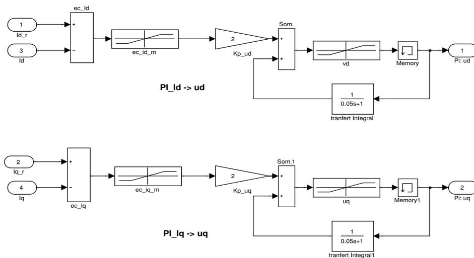
FIG. C.15: Bloc des boucles de courants.
