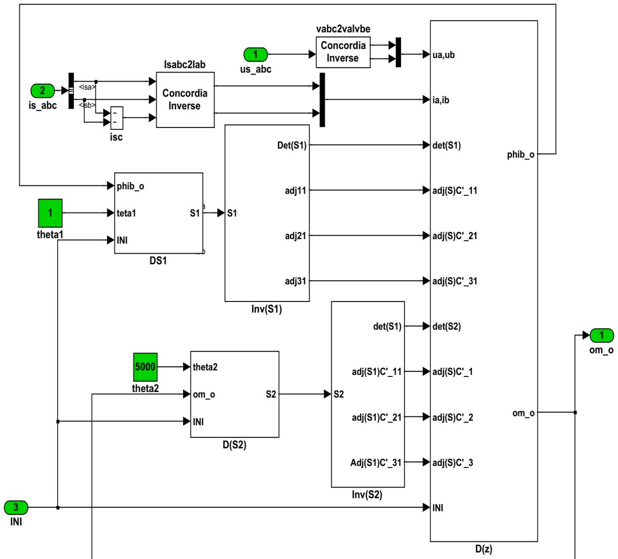
FIG. C.2: Fenêtre principale des deux observateurs interconnectés.
