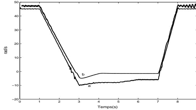
FIG. 4.9: -50% sur  $R_r$ . a) Vitesse mesurée, b) Vitesse estimée (rad/s) en fonction du temps (s).
