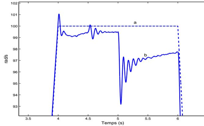
FIG. 5.3: Vitesse de référence (a) et vitesse de la machine (b) zoomées à haute vitesse, (rad/s).
