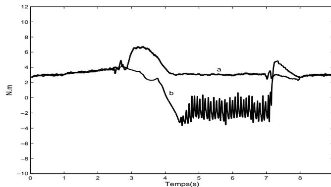
FIG. 4.3: a) Couple de charge mesuré, b) Couple de charge estimé, (N.m) en fonction du temps (s).
