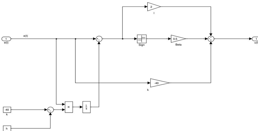
FIG. C.13: Bloc du contrôleur à modes glissants.
