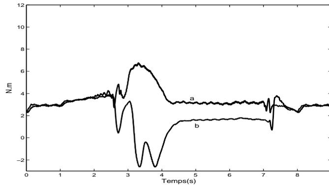
FIG. 4.24: +50% sur  $R_r$ . a) Couple de charge mesuré, b) Couple de charge estimé (N.m) en fonction du temps (s).
