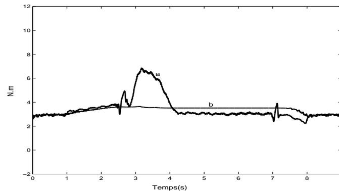
FIG. 4.46: -50% sur  $R_s$ . a) Couple de charge mesuré, b) Couple de charge estimé (N.m) en fonction du temps (s).
