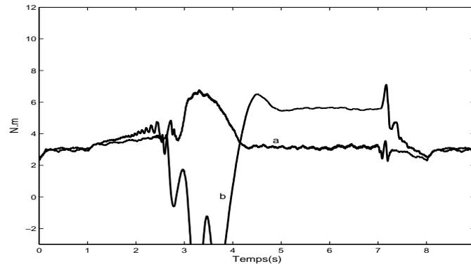
FIG. 4.30: -20% sur  $R_s$ . a) Couple de charge mesuré, b) Couple de charge estimé (N.m) en fonction du temps (s).
