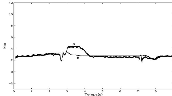
FIG. 4.6: a) Couple de charge mesuré, b) Couple de charge estimé (N.m) en fonction du temps (s). Commutation Observateur/Estimateur.
