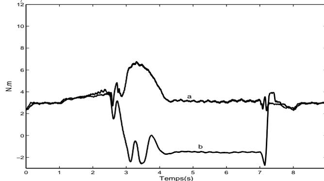
FIG. 4.22: a) Couple de charge mesuré, b) Couple de charge estimé (N.m) en fonction du temps (s). Commutation Observateur/Estimateur.
