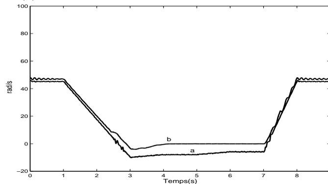
FIG. 4.25: -50% sur  $R_r$ . a) Vitesse mesurée, b) Vitesse estimée (rad/s) en fonction du temps (s).
