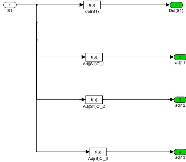
FIG. C.7: Bloc de l'inverse de la matrice  $S_1$  .
