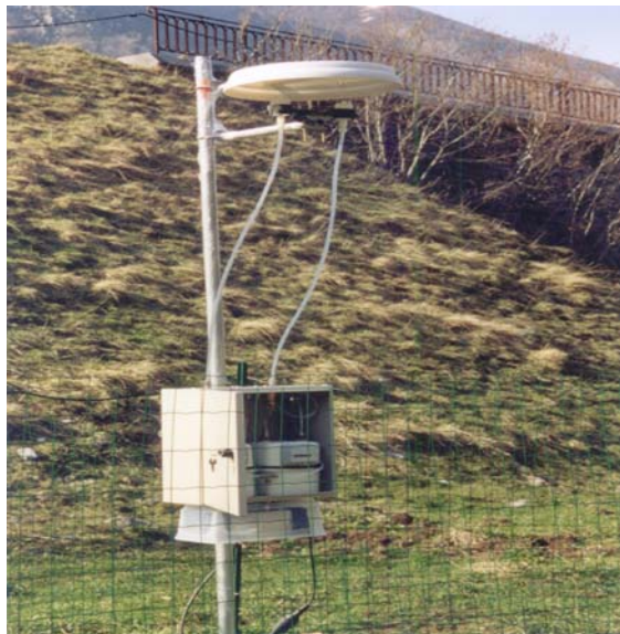
Figure 12 : Système de prélèvement des particules atmosphériques du LCABIE.
