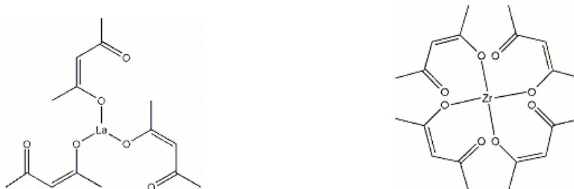
Figure 2-9 : représentations schématiques des précurseurs, La(III)2,4-pentanedionate et Zr(IV)2,4-pentanedionate.
