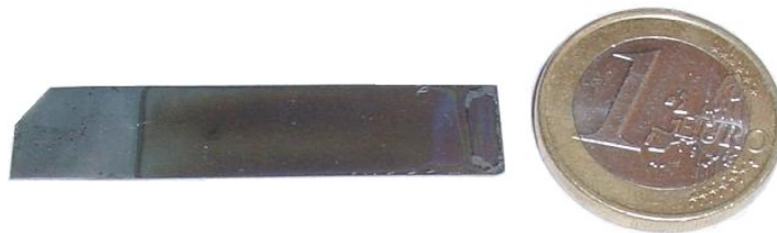
Figure 3-37 : dépôt de LZO sur un substrat de Constantan.
