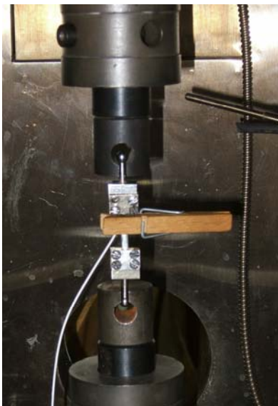
Figure II.11. Essai de traction sur un monocristal de Cd.
