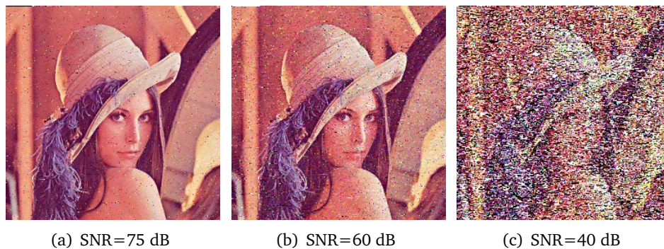
FIG. 3.21 - Images décryptées en présence de bruits de transmission, pour différents SNR, avec \sigma = 10
