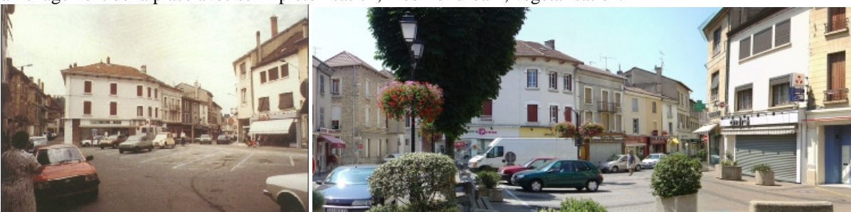
Photographies 9 (Source : Projet de contrat petite ville) et 10 : La Tour-du-Pin, place de la Nation, en 1984 et 2004 ; noter le pavage des sols, l'implantation de mobilier urbain, de lampadaires « tradition », le fleurissement, la requalification du bâti et des façades.
