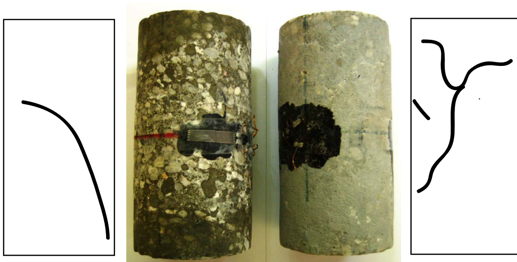
FIG. 4.13 – Faciès de rupture des essais TRX50 et PRP02
