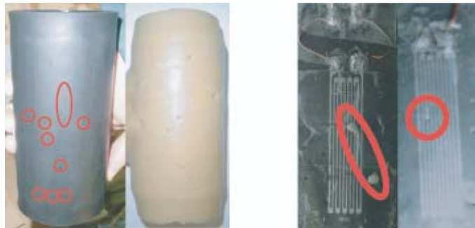
FIG. 2.12 – Photos illustrant la perforation des membranes et des jauges
