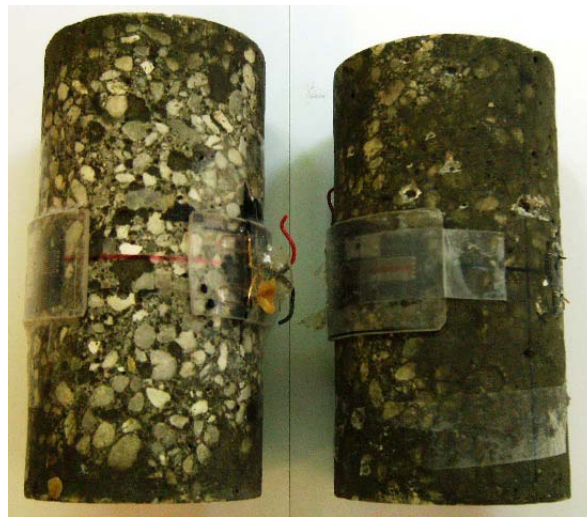
FIG. 4.9 – Faciès des essais hydrostatiques (à gauche) et PRP05 (à droite)
