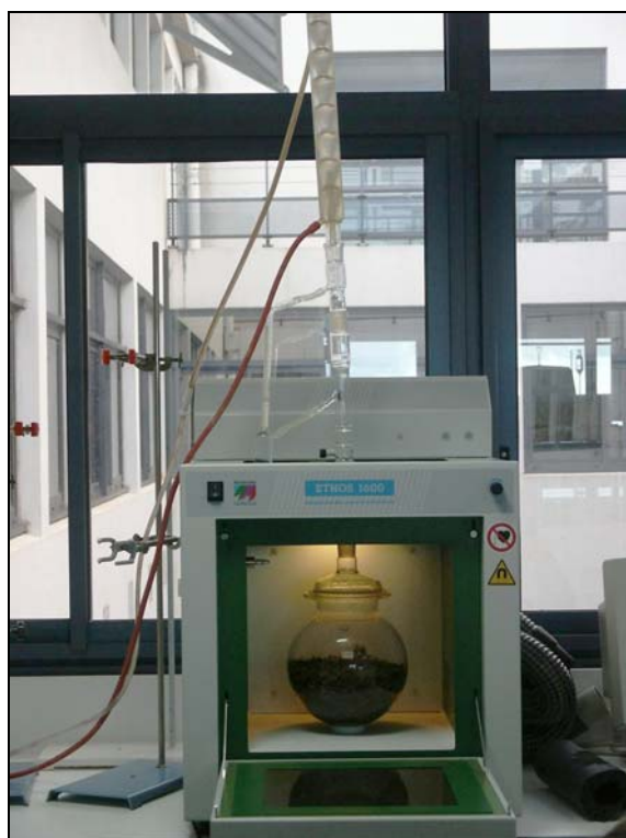
Planche II.1 : Montage de l'extraction sans solvant assistée par micro-ondes.
