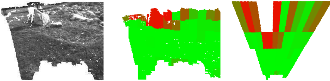
FIG. 4.8 – Un exemple de résultats de la classification Bayesienne par attributs géométriques. De gauche à droite : image montrant les pixels auxquels l’algorithme de stéréovision a pu associer une profondeur, description de la zone perçue avec probabilités partielles pour chaque cellule d’être un obstacle (plus c’est clair plus c’est traversable), et re-projection de ces probabilités dans le repère capteur.
