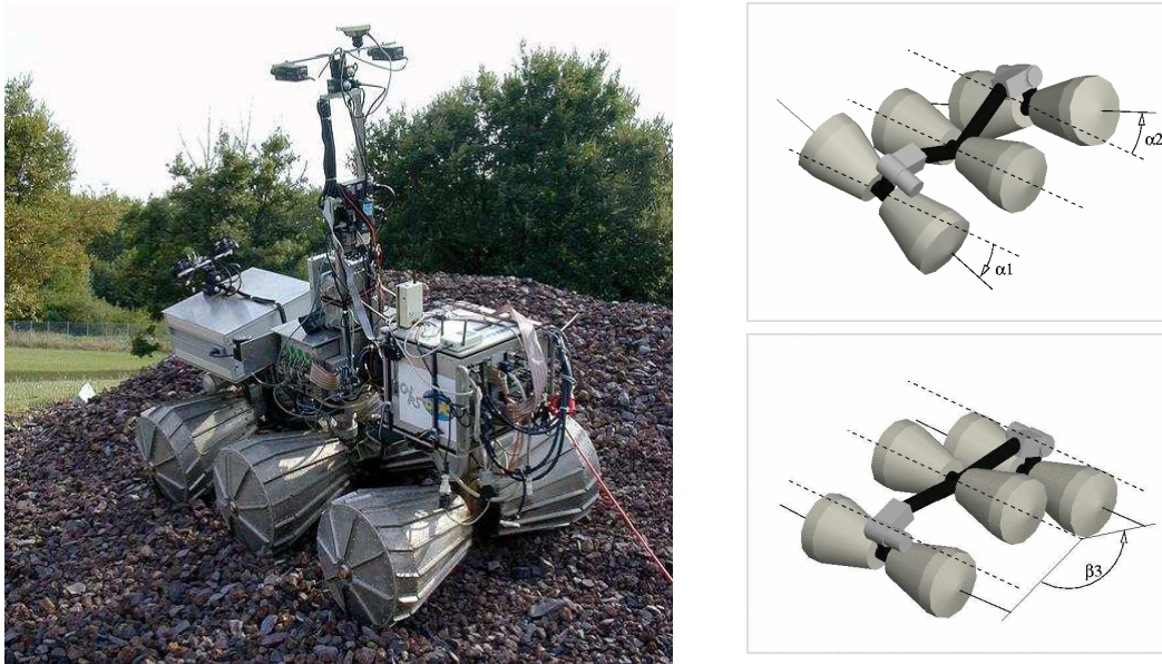
FIG. 3.2 – Le robot Lama et son châssis articulé
