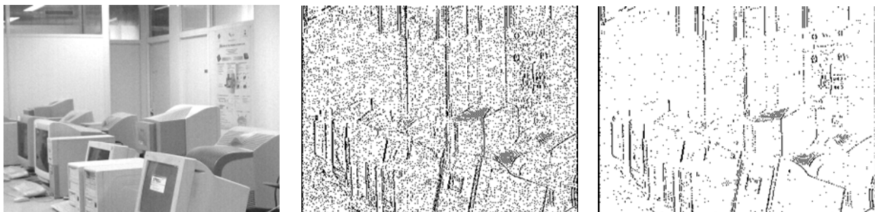
Figure IV.16. Image bruitée et résultats de l'extraction des contrastes verticaux avec un seuil égal à 3% de la dynamique, et 6% de la dynamique (de gauche à droite).
