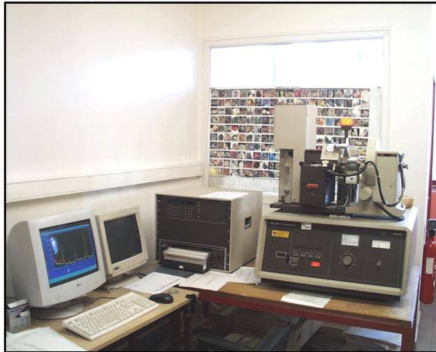
Photo 2-3: diffractomètre à rayons X (Philips PW 1729) (source: [http://www.univ-lille1.fr/geosciences/umr\\_pbds/techniques/rayons\\_x.html](http://www.univ-lille1.fr/geosciences/umr_pbds/techniques/rayons_x.html) )
