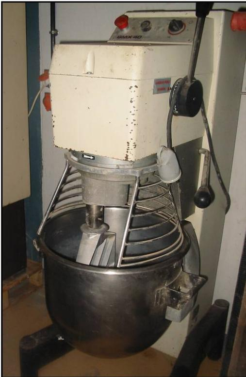
Photo 3-3: malaxeur à vitesse variable pour la confection des mortiers de 2<sup>ème</sup> phase.
