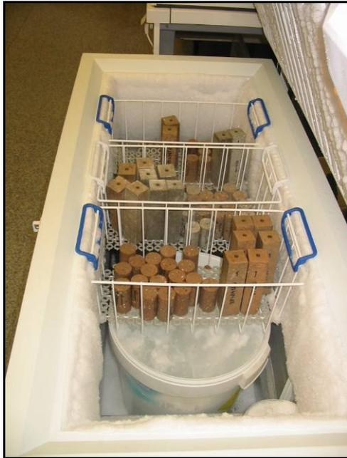
Photo 3-5 : 2<sup>ème</sup> phase gel/dégel (air -22°C; eau 20°C ± 2°C)
