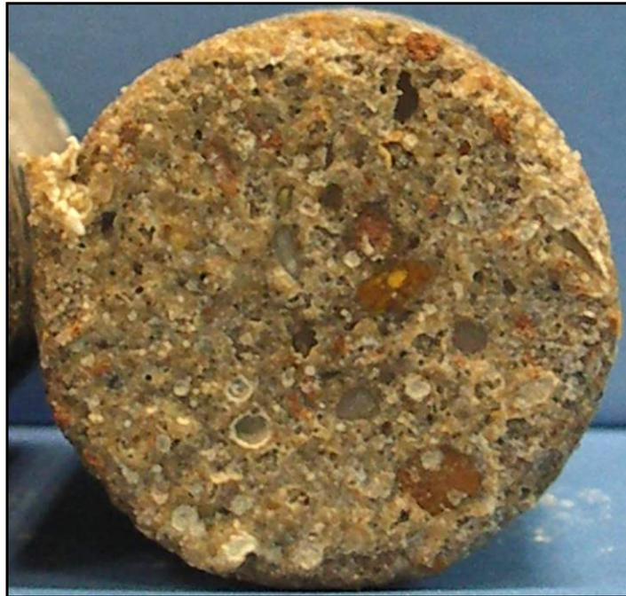
*Photo 4-11: détail de la dégradation de la surface supérieure d'un échantillon de mortier MS33 0.315/4.*
