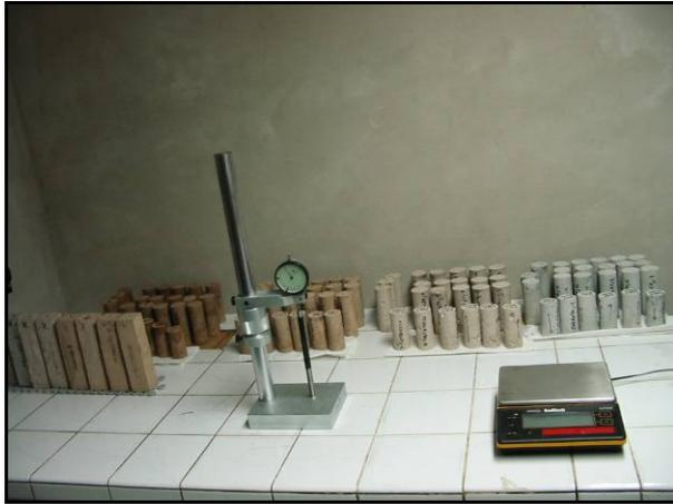
Photo 3-1: échantillons de 1ère phase en cure à l'air (atmosphère contrôlée: T 20°C et 60% H.R.)
