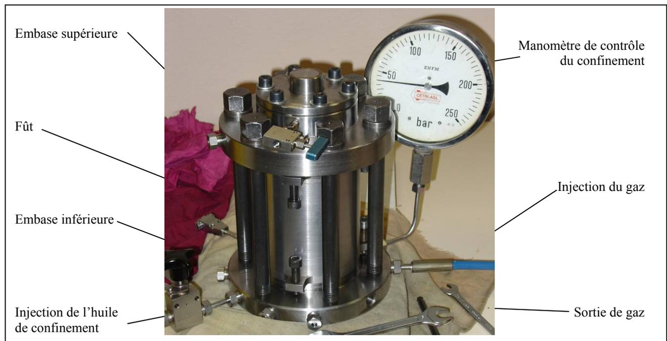
Photo 4-2: cellule hydrostatique de mesure de la perméabilité.
