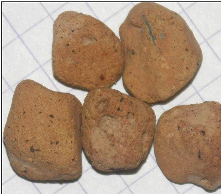
*Photo 2-6: vue macroscopique de granulats de sédiments "DFS" traités lavés sur tamis 80µm (graduation: 5mm)*
