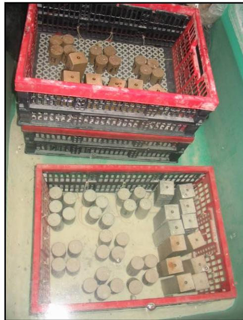
Photo 3-4: échantillons 2<sup>ème</sup> phase en cure à l'eau ( $20^{\circ}\text{C} \pm 2^{\circ}\text{C}$ )
