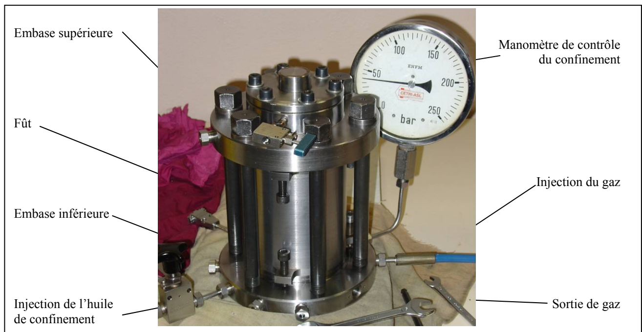
Photo 4-2: cellule hydrostatique de mesure de la perméabilité.
