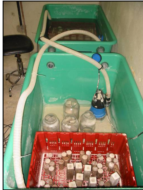
Photo 3-6: 2 ème phase immersion eau de mer (20°C ± 2°C) et marnage (cycles de 6h).
