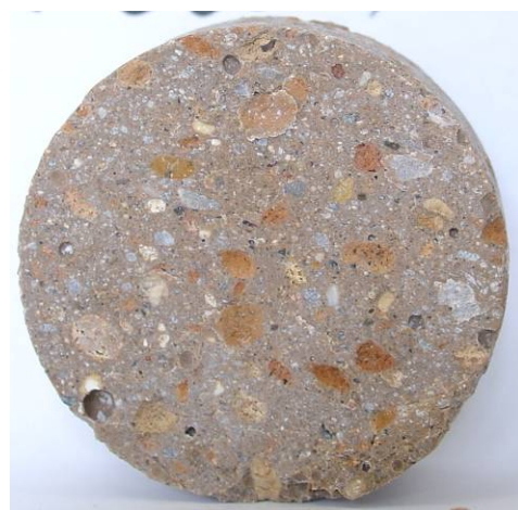
Photo 4-6 : échantillon de mortier MS33 0.315/4 après 30 cycles de gel/dégel.
