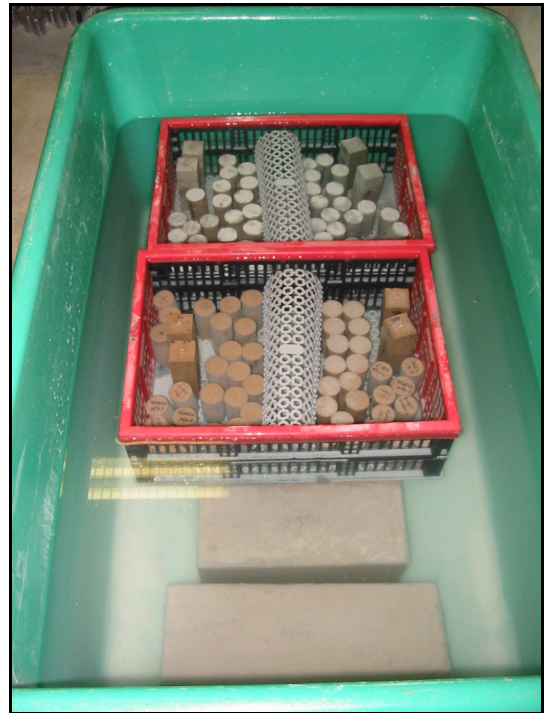
Photo 3-2: échantillons 1ère phase en cure à l'eau (Température 20°C).
