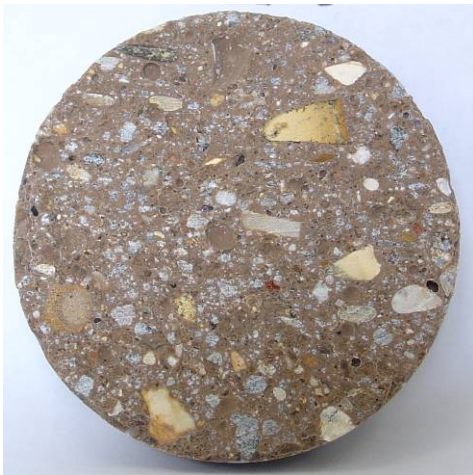
Photo 4-5: échantillon de mortier MS33 0/0.315 après 30 cycles de gel/dégel.
