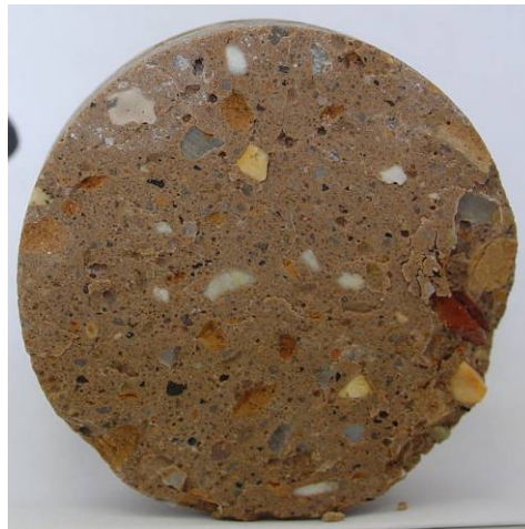
Photo 4-7: échantillon de mortier MS50 après 38 cycles de gel/dégel.
