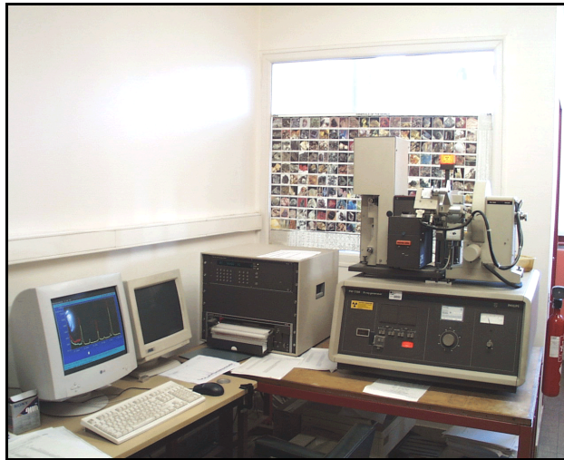
Photo 2-3: diffractomètre à rayons X (Philips PW 1729) (source: http://www.univ-lille1.fr/geosciences/umr_pbd/techniques/rayons_x.html )
