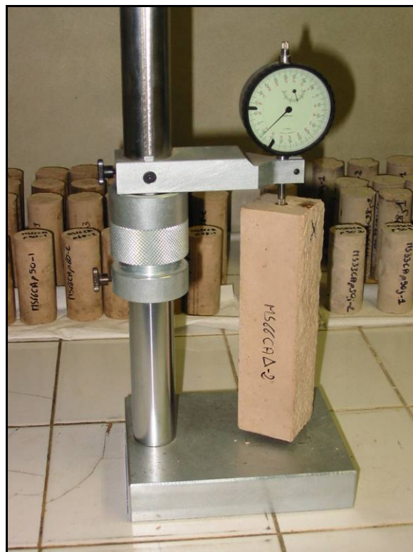
Photo 4-1: comparateur mécanique pour la mesure des déformations des éprouvettes 4x4x16.
