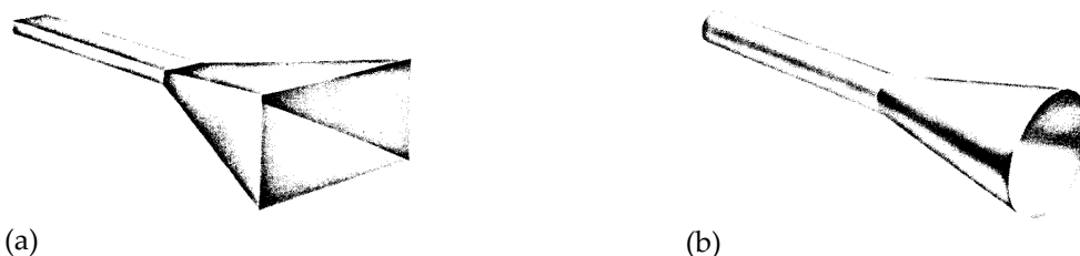
Fig. AI-1: différentes formes d'antennes à ouverture: rectangulaire (a) et circulaire (b)
