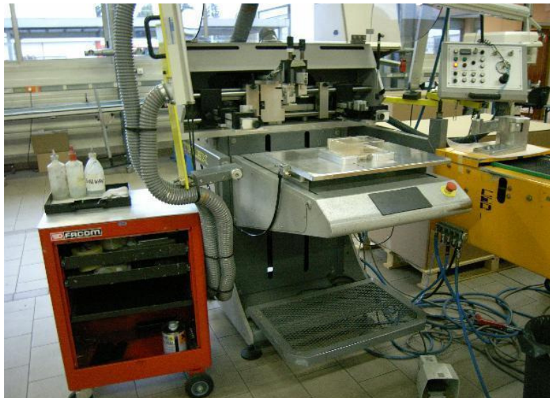
Fig. IV-11: banc de sérigraphie industrielle
