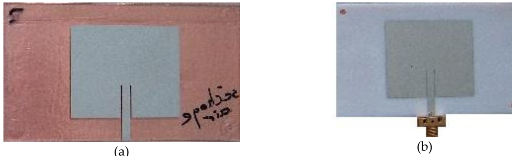
Fig. V-15: encre conductrice à base d'argent déposée sur PC (a) et PBT (b)
