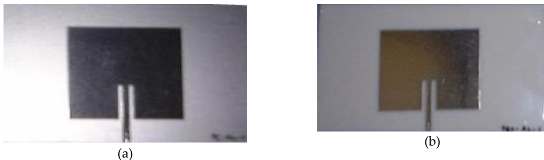
Fig. V-23: antennes patch rectangulaires réalisées par laminage de ruban adhésif en aluminium sur PC (a) et PBT (b)
