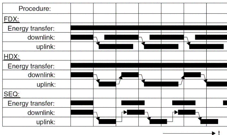
Fig. I-6: procédures de transfert de données et d'énergie, bidirectionnelle simultanée (FDX), bidirectionnelle alternée (HDX) et séquentielle (SEQ)
