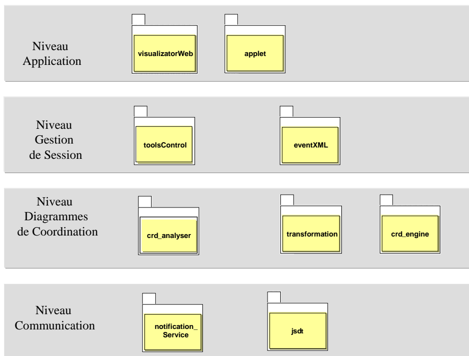
Figure 3.14. Paquetages pour l'implantation
