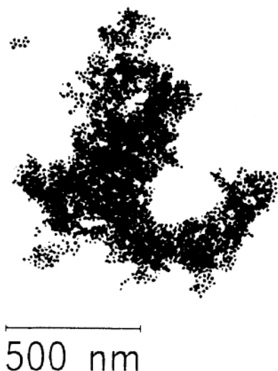
FIG. 5.23 – Image de microscopie électronique d’un agrégat de colloïdes d’or créé par RLCA (tirée de Weitz et al.)
