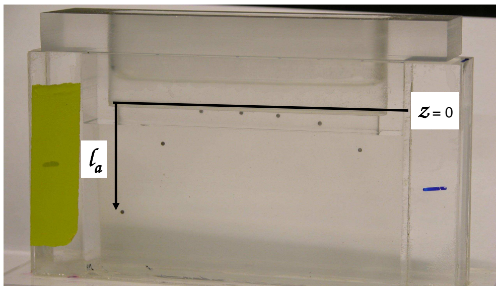
FIG. 3.I.17 – Photo d'une cellule en fin de sédimentation (12 heures après l'introduction des particules dans la colonne de sédimentation). Les 5 particules à droite sont des particules d'aluminium. Elles ont été lâchées toutes les 15 min (la première près du bord droit). Les 2 particules à gauche sont des particules de laitton lâchées également à 15 min d'intervalle. La longueur d'arrêt l_a représentée correspond à une particule de laitton.
