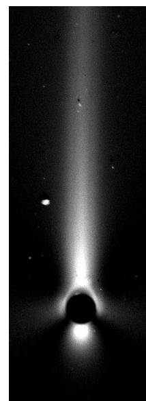
FIG. 3.III.5 – Image brute lorsque les axes des polariseur et analyseur sont à 45^\circ de la verticale. Particule de laiton t_w = 45 min.
