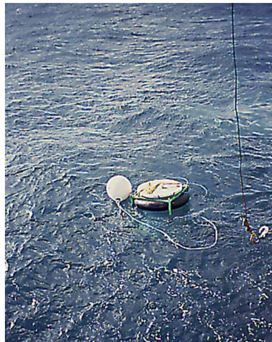
photo 4 : vue de la cuve avec système de flottabilité et flotteur
