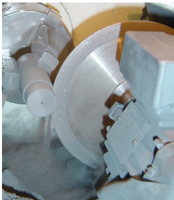
FIG. 1.1 – Tronçonnage après tournage
