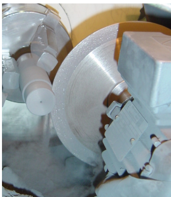
FIG. 1.1 – Tronçonnage après tournage
