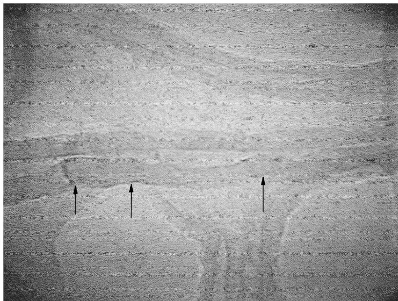
FIG. 4.3 – Observation MET de tubes de Nanocyl présentant des défauts structuraux induisant une courbure du tube (flèche).
