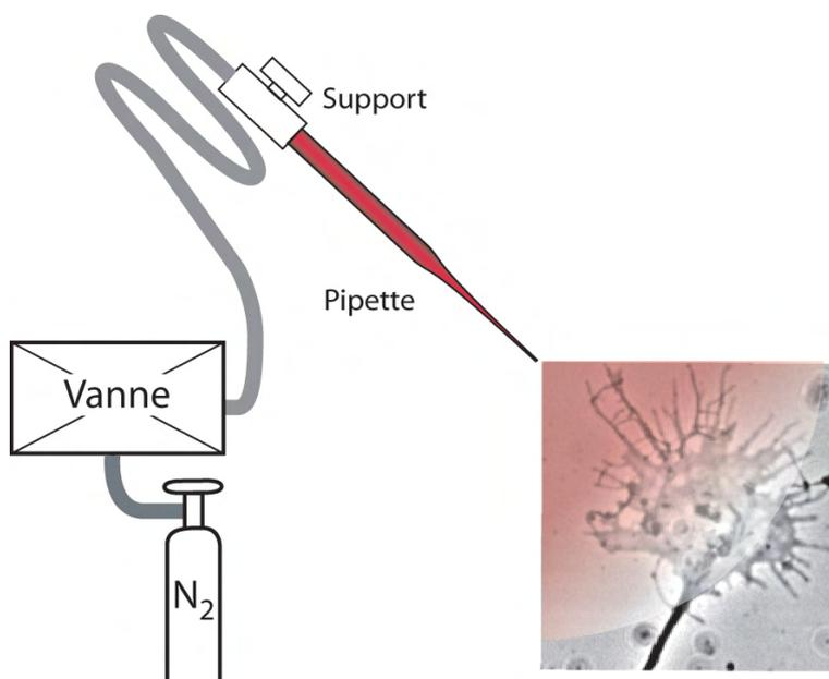
FIG. 3.3 – Schéma du dispositif de guidage artificiel
