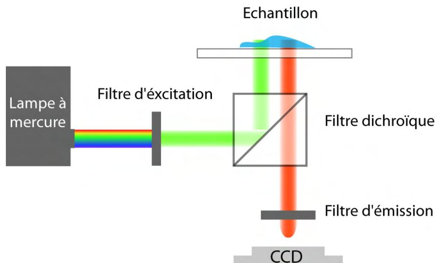
FIG. 2.5 – *Microscope de fluorescence : schéma.*
