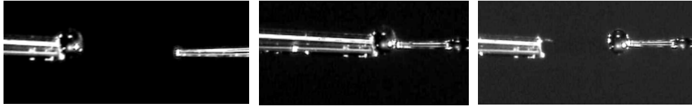
FIG. 4.2 – Phases successives du montage d’une sphère (à gauche la micro-pipette, à droite la fibre amincie et entre les deux, la sphère)
