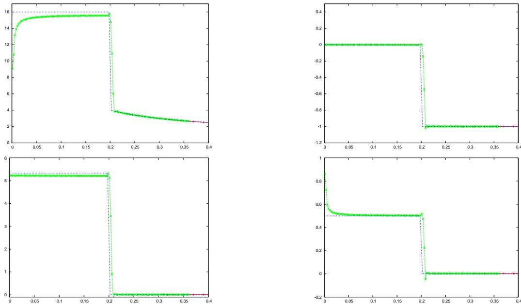
FIG. 4.11 – Problème de Noh, deux grilles,  $dx1 = 1/50$ ,  $dx2 = 1/400$ ,  $M'_4$ , solveur de Riemann. De haut en bas et de gauche à droite : densité, vitesse, pression et énergie interne. Solution exacte en bleu, solution sur la grille grossière en rouge, et solution sur la grille fine en vert.
