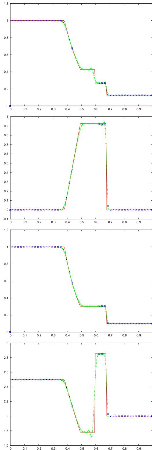
FIG. 4.8 – Tube à chocs de Sod, deux grilles,  $t = 0.1$ , adaptation des grilles suivant le critère (4.1), différences finies centrées. De haut en bas : densité, vitesse, pression et énergie interne. Solution exacte en rouge, solution sur la grille grossière en bleu, et solution sur la grille fine en vert. Une particule sur deux affichée.
