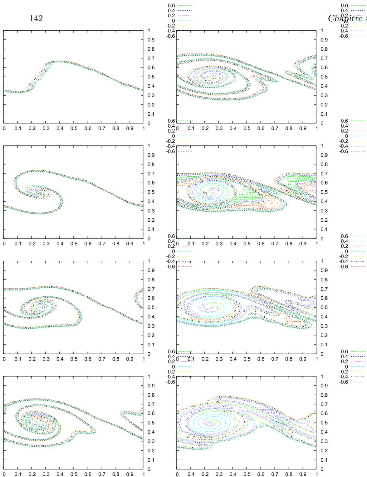
FIG. 5.5 – Instabilité de Kelvin Helmholtz, résultats avec la méthode particulaire pour les conditions initiales de Mulder et al., isolignes de  $\phi$  : -0.6, -0.4, -0.2, 0., 0.2, 0.4, 0.6, de haut en bas et de gauche à droite aux temps  $t = 1., 2., 3., 4., 5., 6., 7., 8..$
