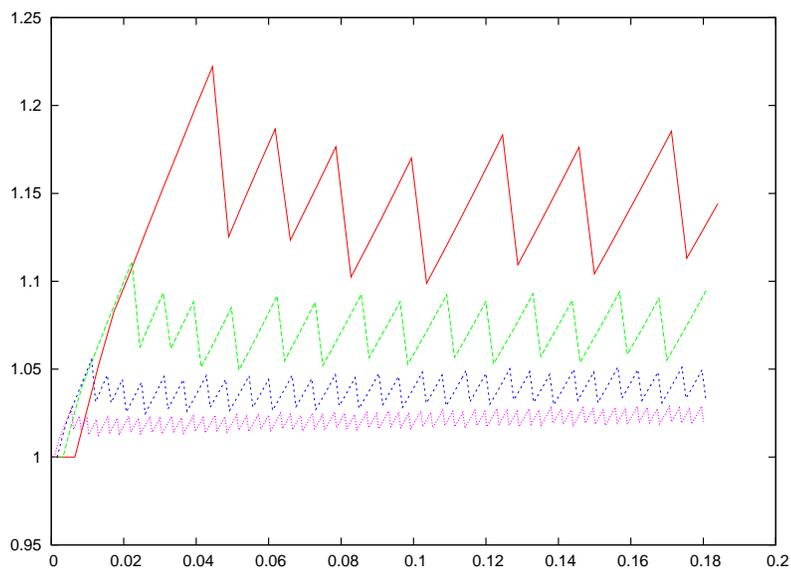
FIG. 5.2 – Même légende que la figure précédente. Evolution du rapport  $\frac{\text{masse}}{\text{masse initiale}}$  du fluide situé à droite, pour  $dx = 1/50$  (rouge),  $1/100$  (vert),  $1/200$  (bleu),  $1/400$  (rose).
