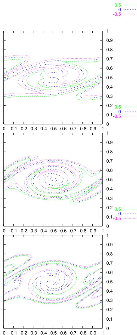
FIG. 5.7 – Instabilité de Kelvin-Helmholtz, résultats avec la méthode particulaire pour les conditions initiales de Després et Lagoutière, isovalues de  $\phi$ , à  $t = 8.$ , remaillage avec  $\Lambda_3$ , de haut en bas :  $50^2$ ,  $100^2$  et  $200^2$  particules,.
