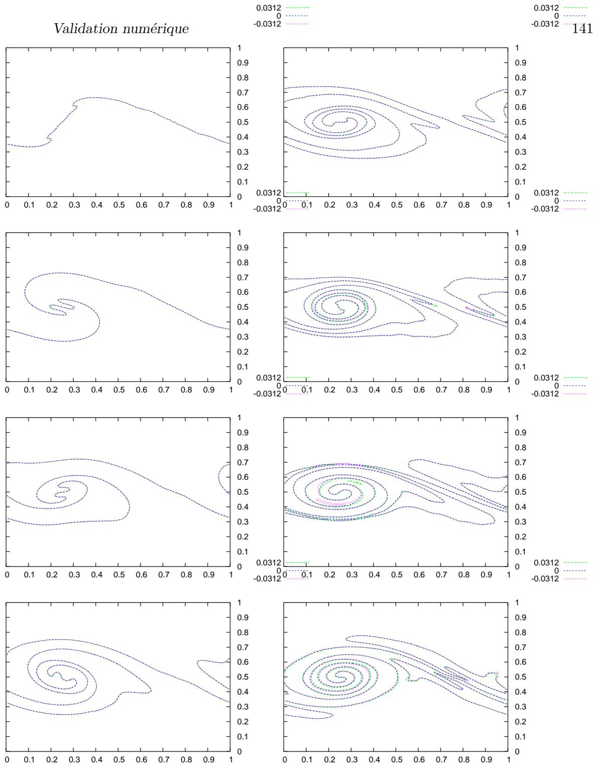
FIG. 5.4 – Instabilité de Kelvin Helmholtz, résultats avec la méthode particulière pour les conditions initiales de Mulder et al., isolignes de  $\phi$  :  $-1/32$ ,  $0$ ,  $1/32$ , de haut en bas et de gauche à droite aux temps  $t = 1, 2, 3, 4, 5, 6, 7, 8$ .
