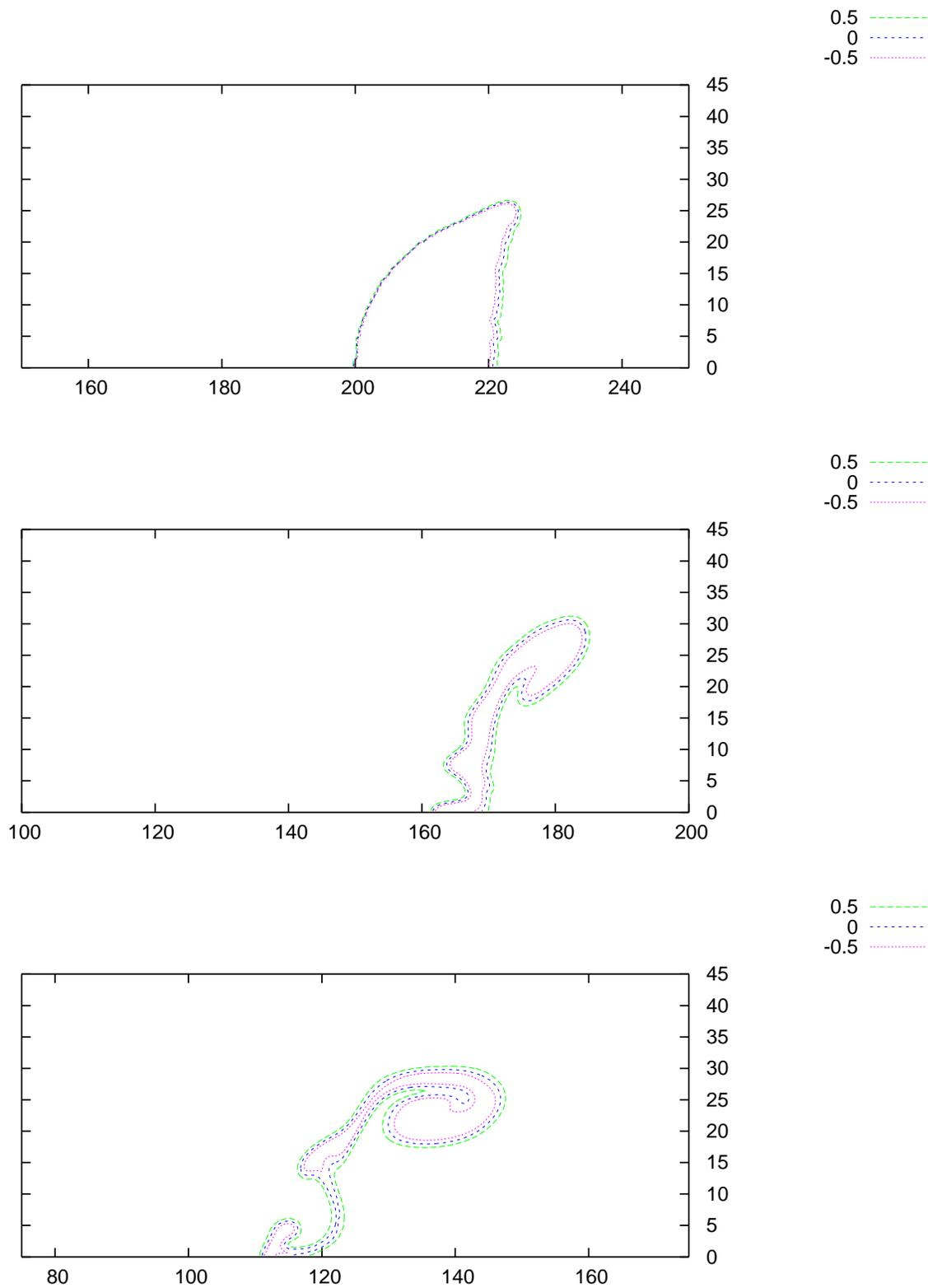
FIG. 5.20 – Interaction choc-bulle, isovalues de  $\phi$ , à  $t = 0.5, 1., 1.5$ ,  $50 \times 500$  particules (discrétisation  $N = 50$ ) pour résoudre l'hydrodynamique, et des particules plus fines ( $N = 100$ ) pour résoudre l'interface, remaillage avec  $\Lambda_3$ .
