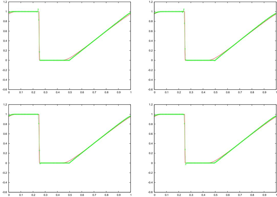
FIG. 3.10 – De haut en bas et de droite à gauche : schéma de Lax-Wendroff et schémas avec les noyaux  $\Lambda_2$ ,  $M'_4$  et  $\Lambda_3$ , corrigés par le terme de viscosité artificielle étudié en 2.2.6 avec un coefficient  $C = 0.2$ , en vert, comparés à la solution entropique, en rouge, à  $t = 0.5$ , 200 particules ou points de grille.
