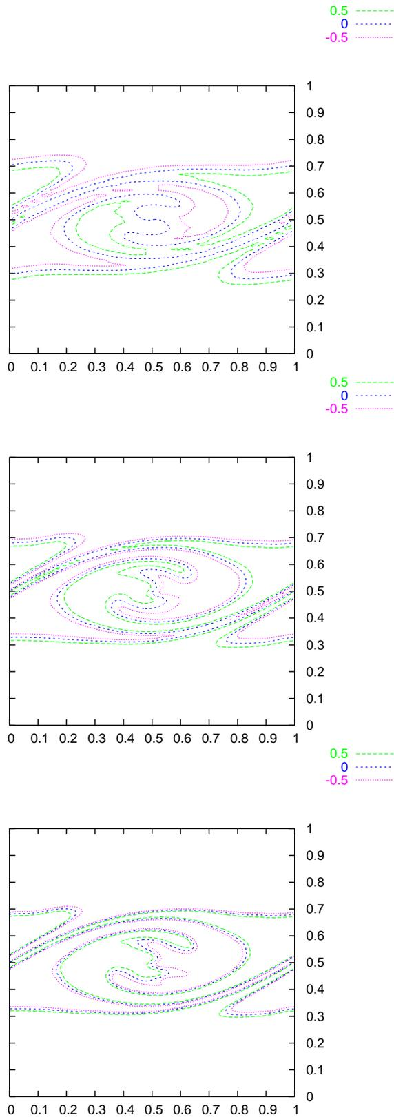
FIG. 2 – Instabilité de Kelvin-Helmholtz, isovaleurs de  $\phi$ , à  $t = 8$ , équations d'Euler résolues avec  $50^2$  particules, de haut en bas  $\phi$  résolu sur une grille  $50^2$ ,  $100^2$  et  $200^2$ .
