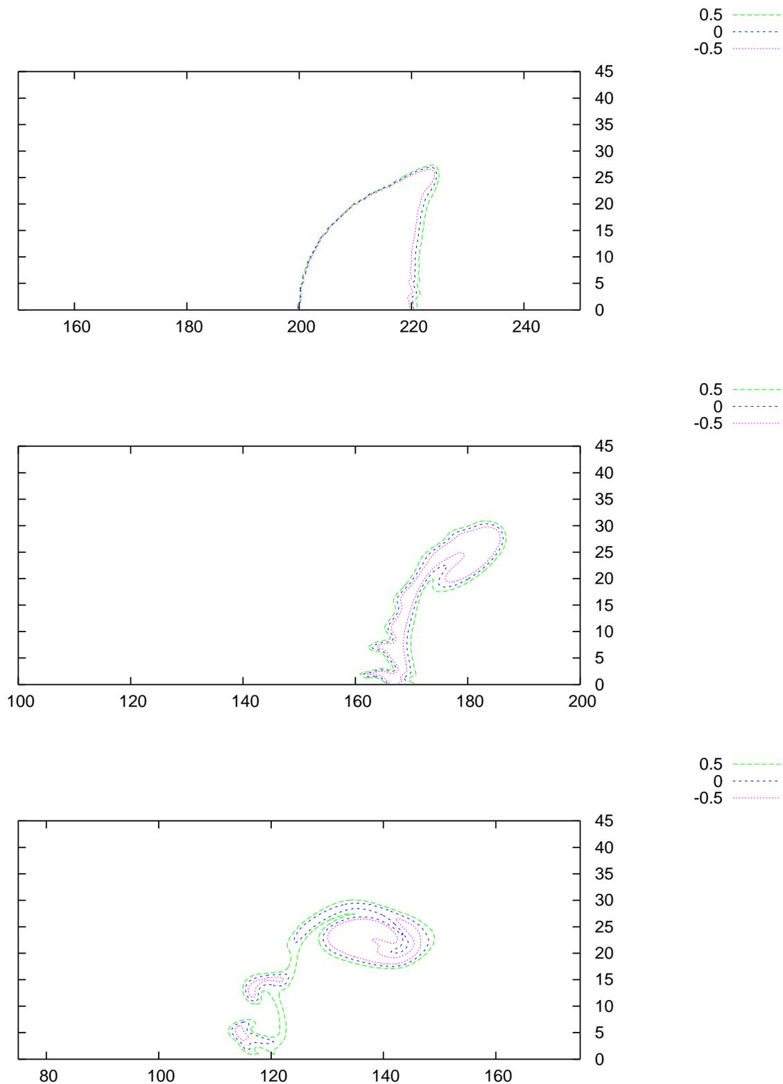
FIG. 5.17 – Interaction choc-bulle, isovalues de  $\phi$ , à  $t = 0.5, 1., 1.5$ , utilisation de deux tailles de particules portant toutes deux les variables des équations d'Euler :  $dx = 1/100$  autour de la bulle et  $dx = 1/50$  ailleurs, remaillage avec  $\Lambda_3$ .
