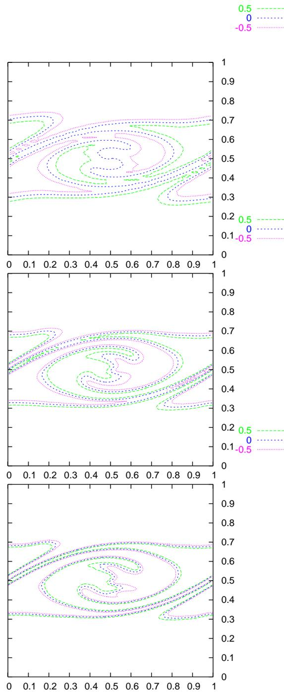
FIG. 5.10 – Instabilité de Kelvin-Helmholtz, isovaleurs de  $\phi$ , à  $t = 8.$ , de haut en bas,  $50^2$  particules,  $50^2$  particules sur la grille grossière et  $100^2$  particules sur la grille fine, qui porte seulement  $\phi$ , et  $50^2$  particules sur la grille grossière et  $200^2$  sur la grille fine, remaillage avec  $\Lambda_3$ .
