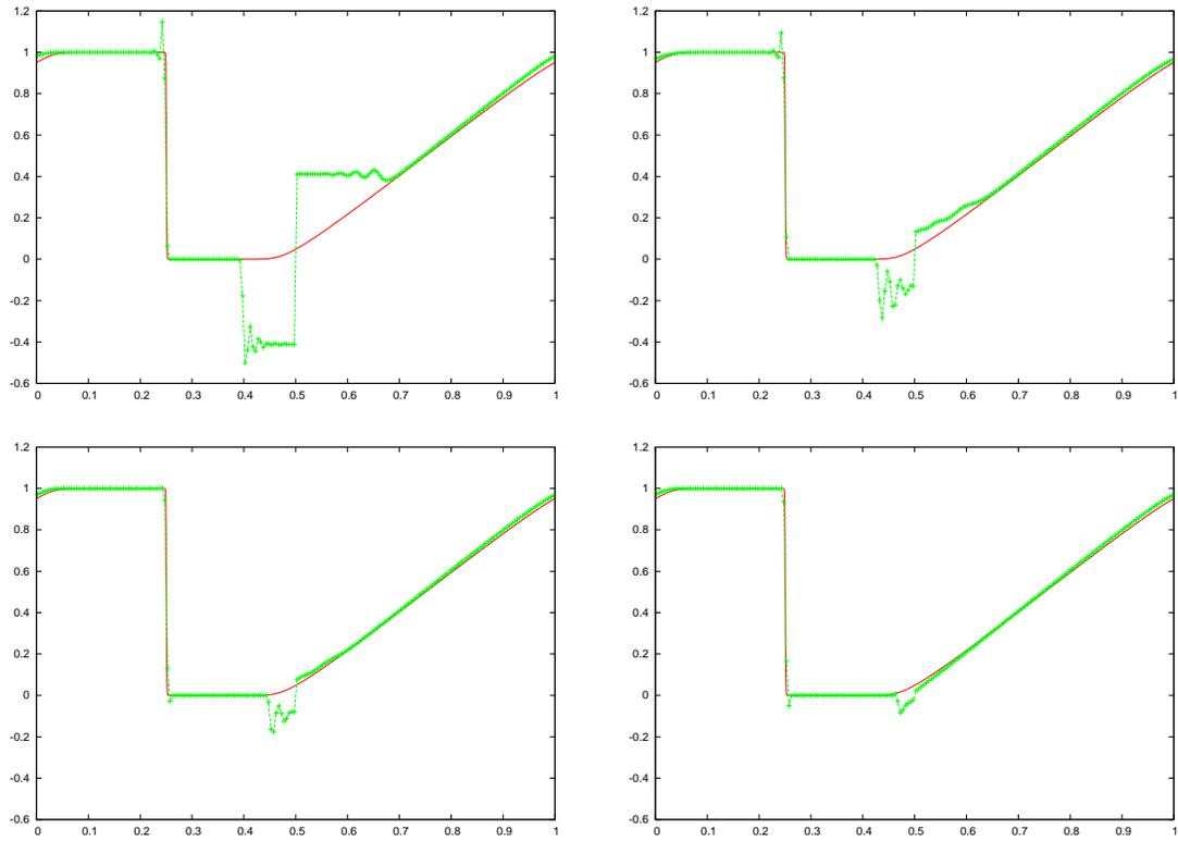
FIG. 3.8 – De haut en bas et de droite à gauche : schéma de Lax-Wendroff et schémas avec les noyaux  $\Lambda_2$ ,  $M'_4$  et  $\Lambda_3$ , en vert, comparés à la solution entropique, en rouge, à  $t = 0.5$ , 200 particules ou points de grille.
