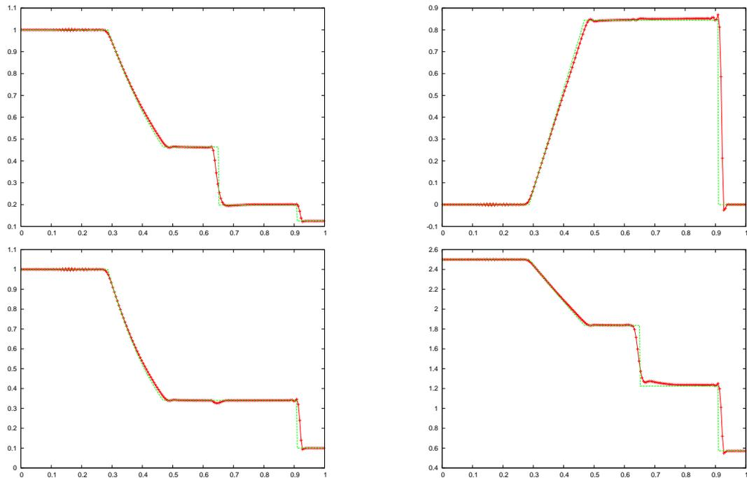
FIG. 5.1 – Tube à chocs de Sod avec  $\gamma = 1.4$  à gauche de la discontinuité initiale, et  $\gamma = 2.4$  à droite,  $N = 200$ , remaillage avec le noyau  $\Lambda_3$ , différences finies centrées d'ordre 3, de gauche à droite et de haut en bas : densité, vitesse, pression, énergie interne.
