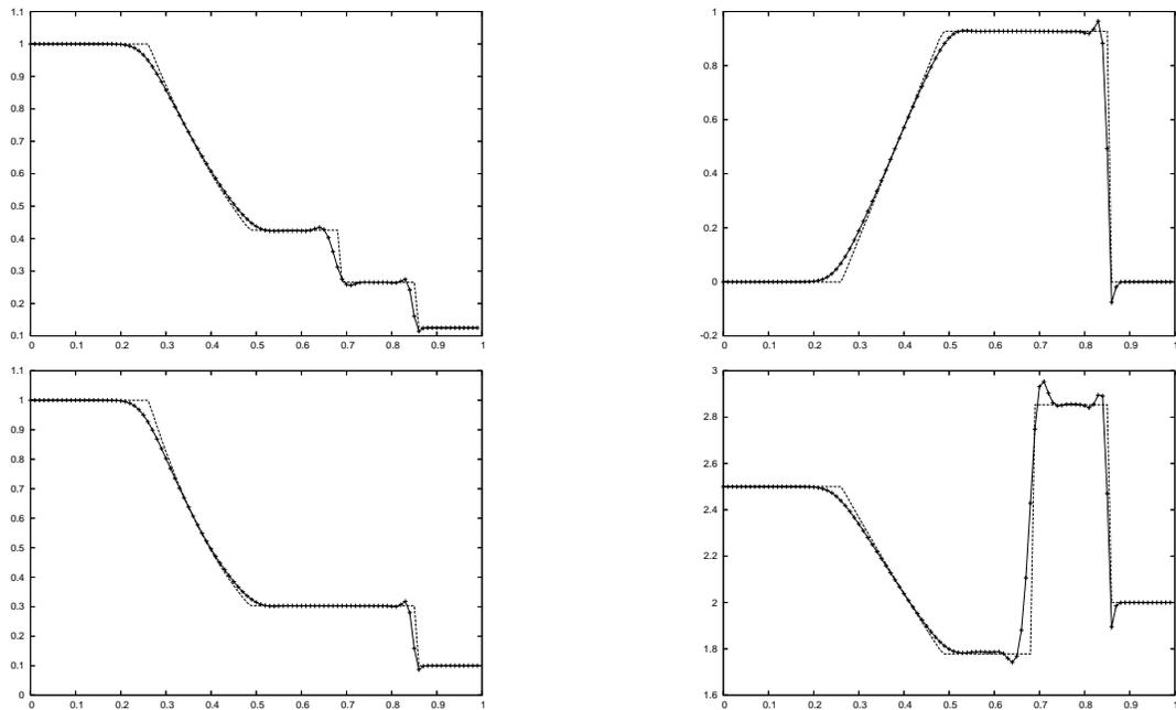
FIG. 3.17 – Tube à chocs de Sod, 100 particules,  $\Lambda_3$ , solveur de Riemann approché, de gauche à droite et de haut en bas : densité, vitesse, pression, énergie interne.
