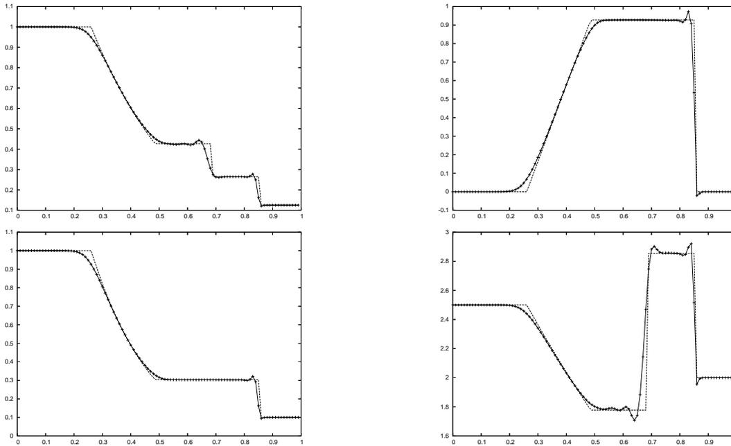
FIG. 3.15 – Tube à chocs de Sod,  $N=100$ ,  $M'_4$ , solveur de Riemann approché, de gauche à droite et de haut en bas : densité, vitesse, pression, énergie interne.
