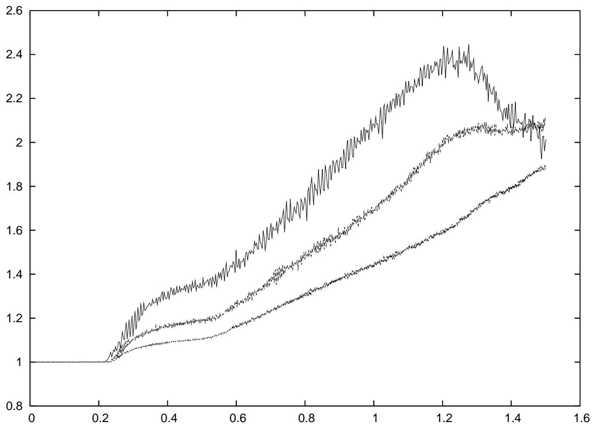
FIG. 5.16 – Interaction choc-bulle, évolution du rapport masse/masse initiale de la bulle, pour (de haut en bas)  $50 \times 500$ ,  $100 \times 1000$  et  $200 \times 2000$  particules, remaillage avec  $\Lambda_3$ .
