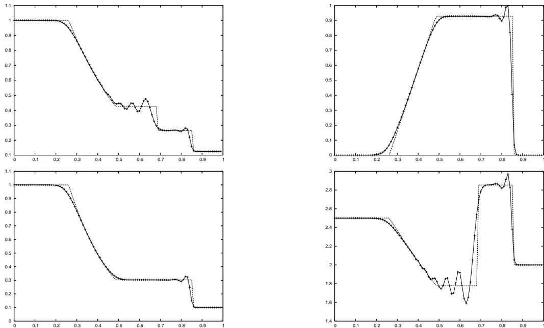
FIG. 3.13 – Tube à chocs de Sod,  $N=100$ ,  $\Lambda_2$ , solveur de Riemann approché, de gauche à droite et de haut en bas : densité, vitesse, pression, énergie interne.
