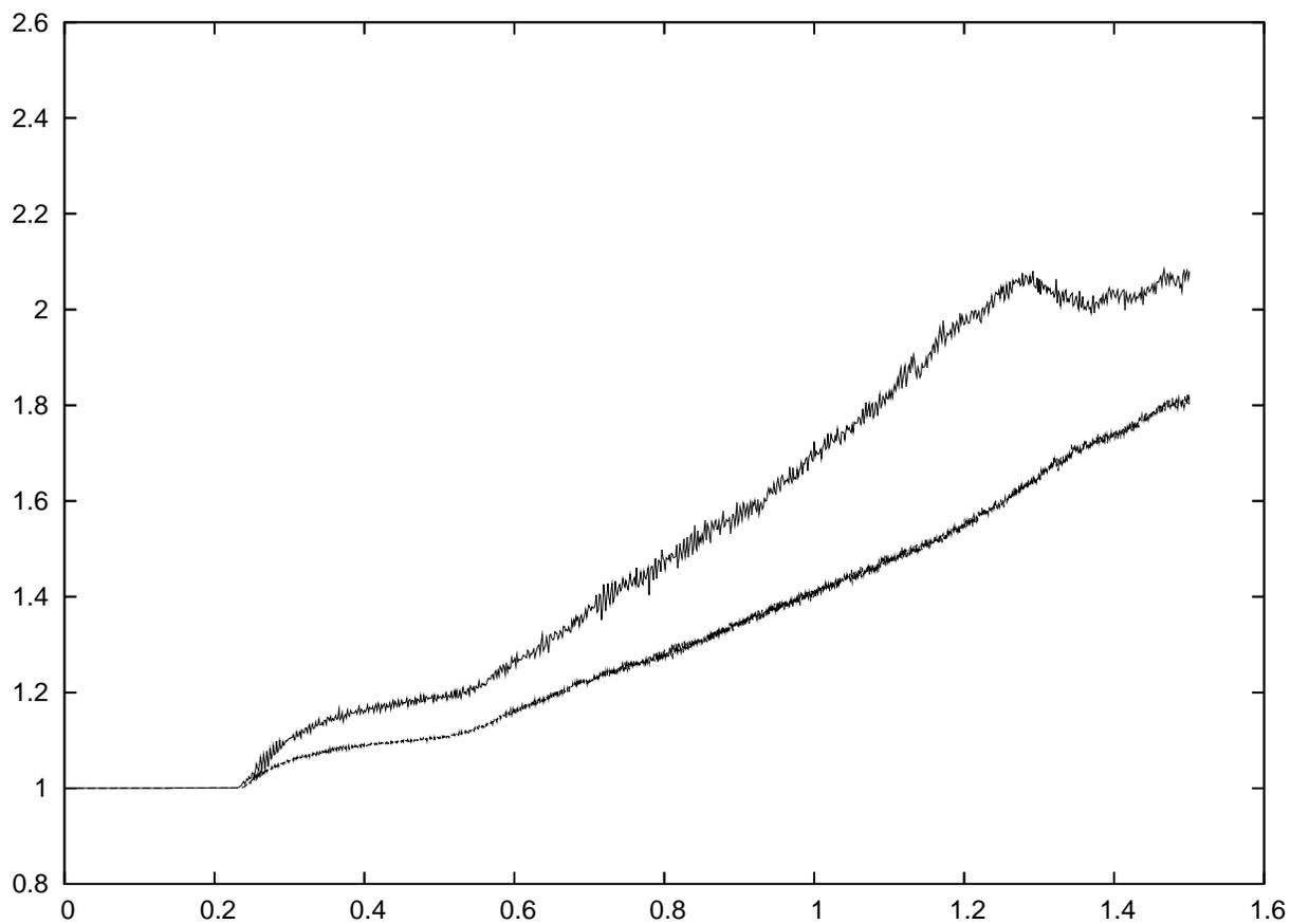
FIG. 5.19 – Interaction choc-bulle, évolution de la masse de la bulle, utilisation de deux tailles de particules portant toutes deux les variables des équations d'Euler :  $dx = 1/50$  et  $dx = 1/100$  autour de la bulle, remaillage avec  $\Lambda_3$ .
