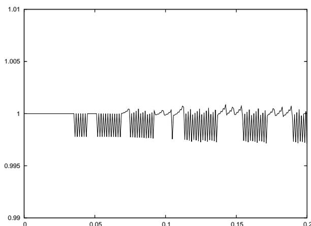
FIG. 4.10 – Tube à chocs de Sod, bigrille adaptative, évolution du rapport masse sur masse initiale en fonction du temps
