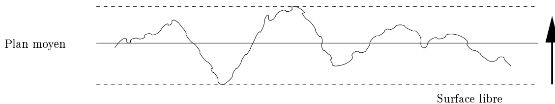
FIG. 2.8 : Le miroir est défini comme un plan parallèle au plan moyen des rugosités. En faisant varier le niveau du miroir depuis le point plus bas jusqu'au plus haut, nous obtenons la série des Cartes des Régions Submergées.
