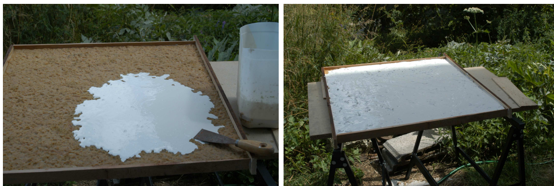
FIG. 2.2 : Nous étalons la résine de polyester sur notre négatif tout en prenant soin d'armer le moulage avec des barres d'aluminium pour empêcher la déformation de l'échantillon lors de la phase de polymérisation de la résine.
