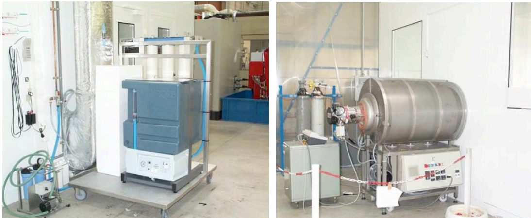
Figure (V.6) : A gauche : station de production d'eau ultra pure. A droite : four pour l'étuvage des coupleurs donnant sur la partie classe 10 de la salle blanche.
