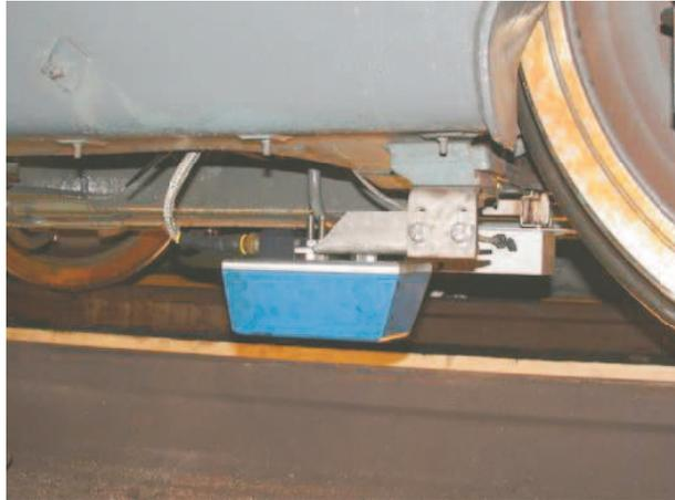
FIG. II.6 – montage du capteur sous le bogie.
