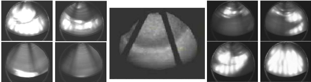
Figure 4.25 : de gauche à droite a) production de la mousse b) homogénéisation après imbibition et c) nettoyage de la mousse, au cours du vol en micropesanteur MAXUS 6 (extraite d'un rapport de EADS-ST, 2004)
